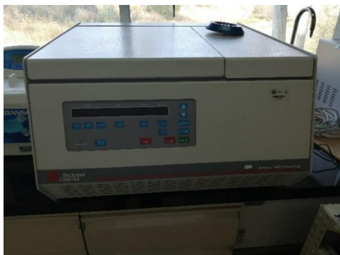
Figura 3. 2. Centrífuga utilizada para la decantación del sólido y obtener el sobrenadante.
