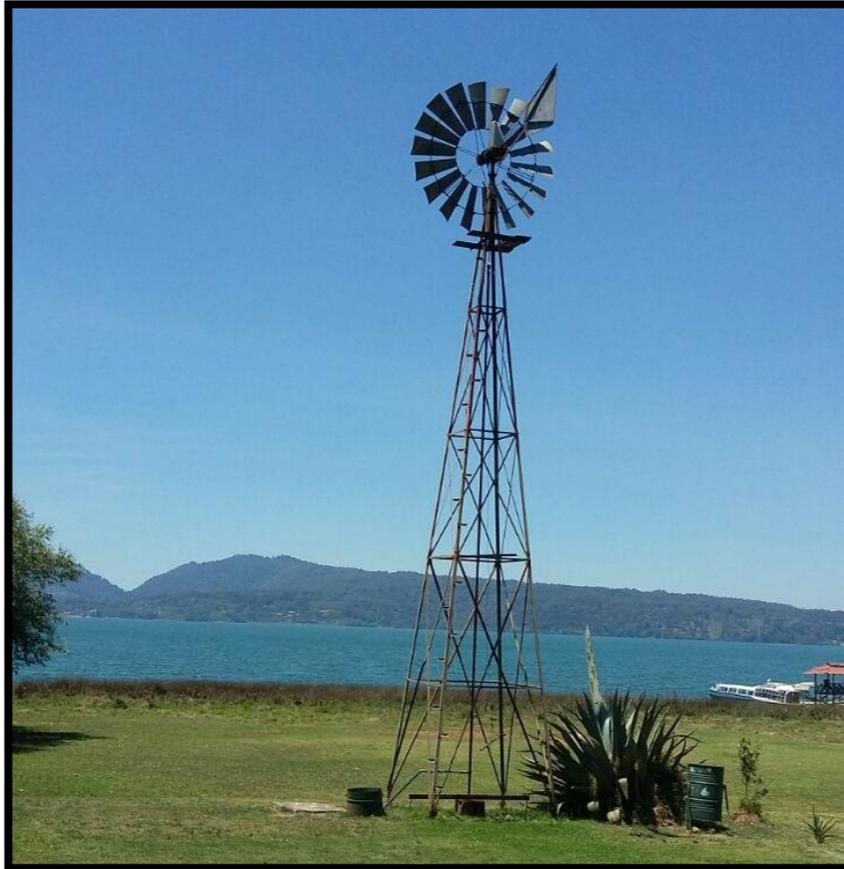
El sistema utilizado para la obtención de agua es el que se muestra en la imagen, el cual consiste en utilizar el viento para poder accionar el mecanismo que a su vez extrae el agua de un pozo
