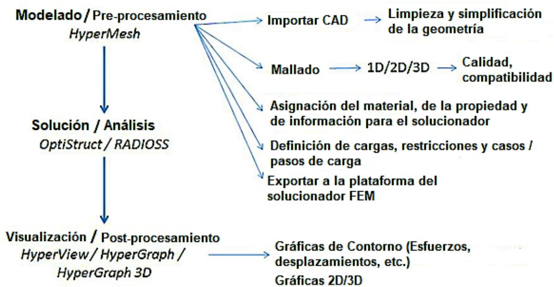
Figura 60. Proceso estándar de un Análisis por Elementos Finitos (FEA) en HyperWorks [42].
