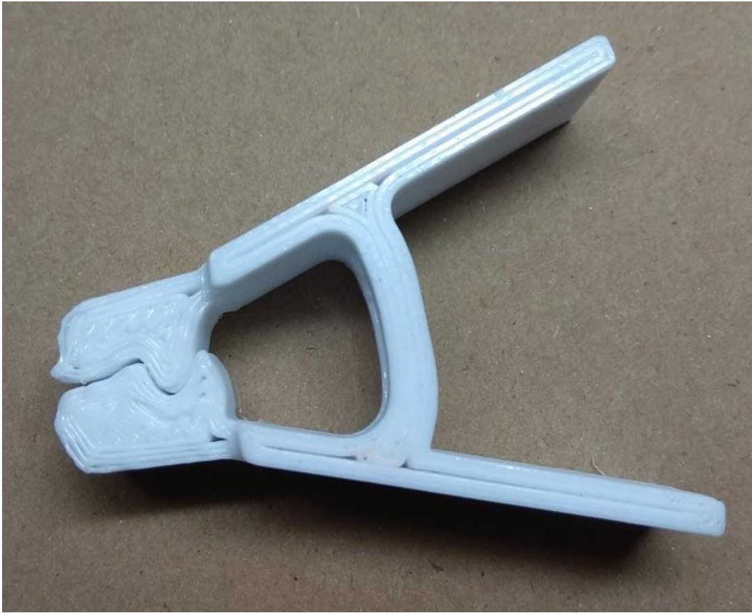
Figura 48. Prototipo rápido fabricado para la verificación experimental del diseño refinado de la optimización topológica.
