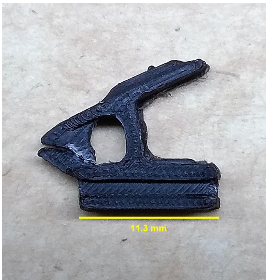
Figura 73. Prototipo del diseño miniaturizado del mecanismo flexible de pinzas.
