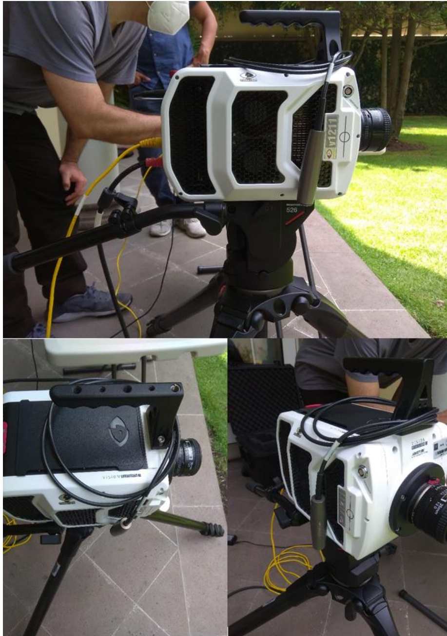
Figura 77. Conexión y configuración de la cámara Phantom v1211 de ultra alta velocidad para la toma de vídeos del experimento.
