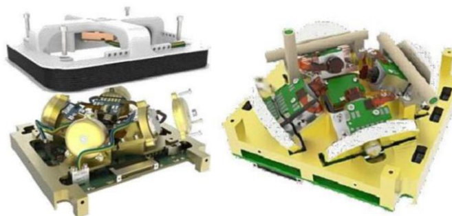
Fig. 1.13: Módulo ADCS del diseño Block 1 (izq.); Módulo ADCS del diseño Block 2 (der.) [50]
