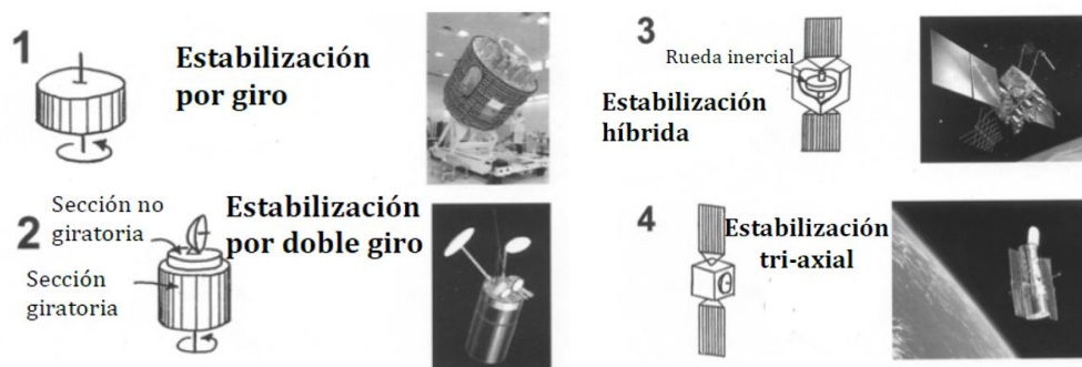
Fig. 1.5: Tipos de estabilización de la orientación en satélites. [28]
