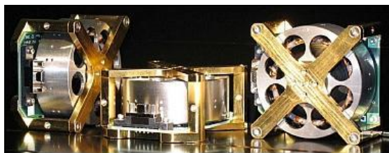
Fig. 1.12: Sistemas de ruedas de reacción utilizadas por el LightSail-1. [45]
