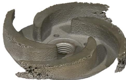
Figura 48. Efecto de la cavitación en impulsor.
