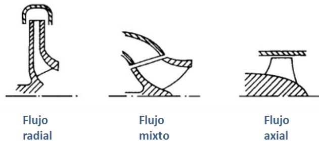
Figura 44. Tipos de flujo en bombas centrífugas.
