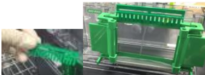
Figura 29. Colocación del peine una vez que el gel inferior ha polimerizado y se ha llenado el espacio restante con la solución del gel superior.
