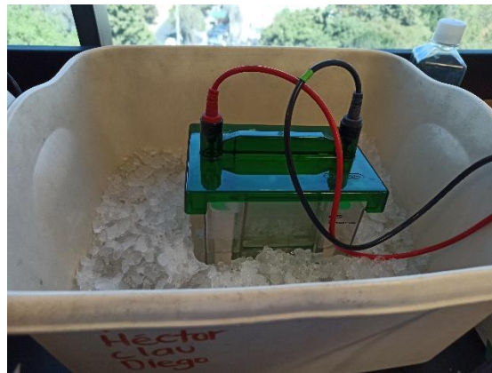
Figura 33. Durante la electroforesis, la cámara debe situarse en hielo para evitar la desnaturalización de las proteínas.
