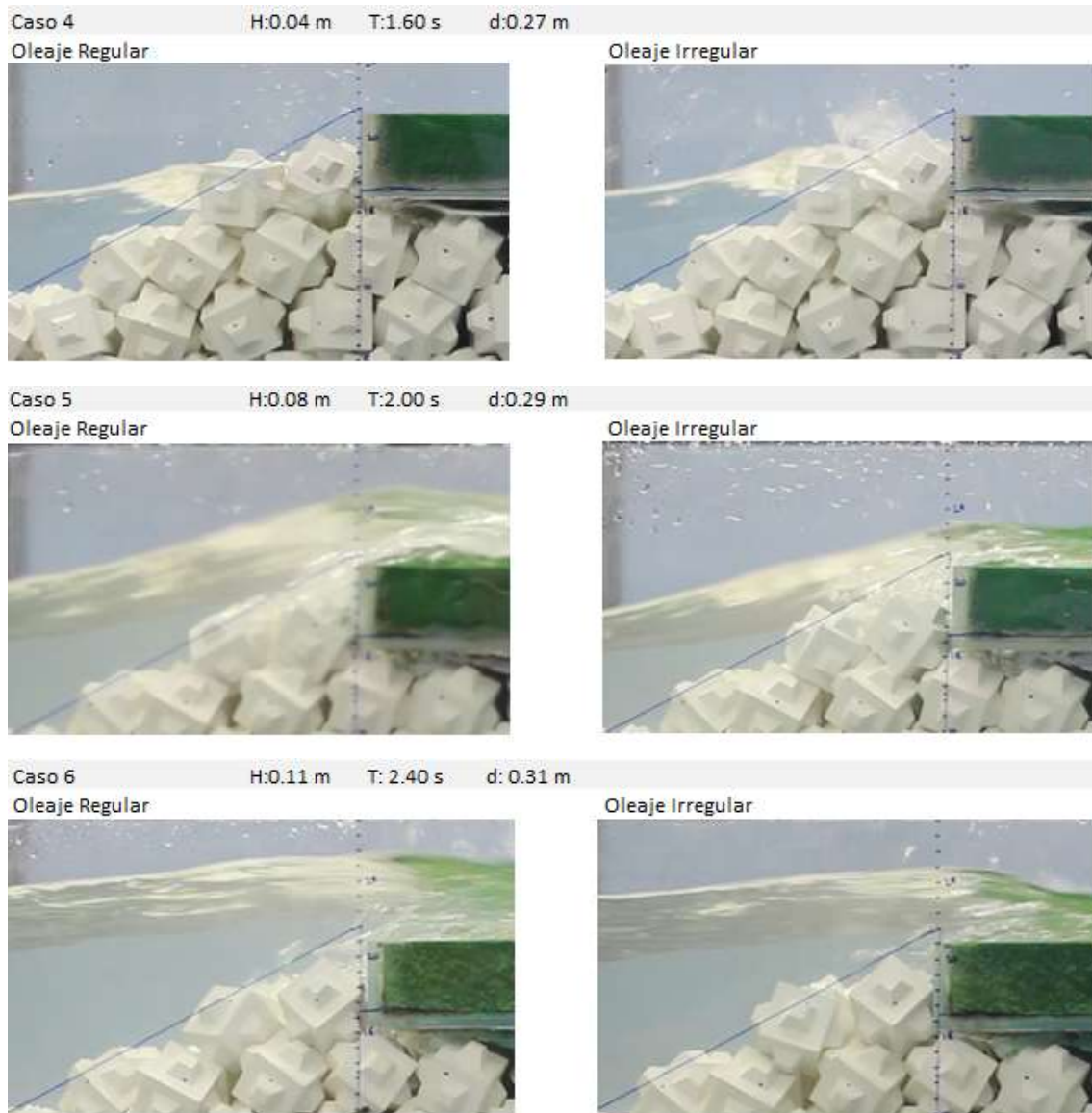
Figura 24. Oleaje por ensayo para identificar presencia de ascenso máximo y rebase.
