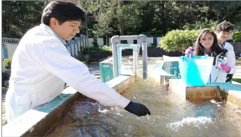
**Figura 5.3. Toma de muestras en el proceso unitario de oxidación química de la PP Río Magdalena 1. Fuente: Elaboración propia.**
