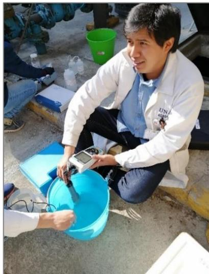
**Figura 5.9. Determinación de parámetros *in situ* en las muestras recolectadas. Fuente: Elaboración propia.**
