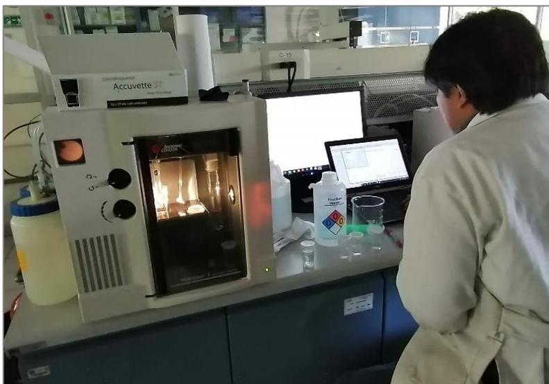
**Figura 5.11. Determinación de la DTP en las muestras recolectadas. Fuente: Elaboración propia.**
