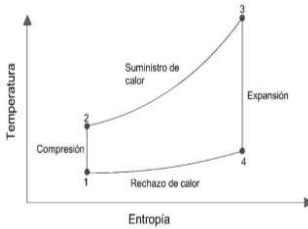
Figura 6. Ciclo Joule, diagrama T-s
