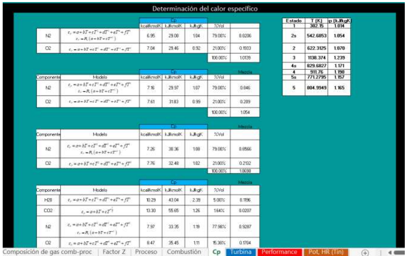
Figura 45. Hoja para el cálculo del calor específicos de los gases en cada estado termodinámico del ciclo termodinámico Joule.
