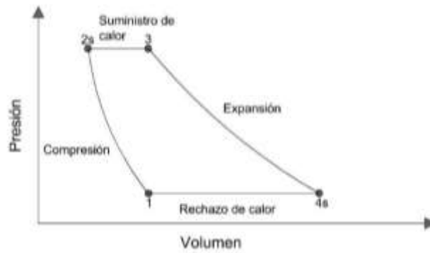
Figura 7 Ciclo Joule, diagrama P-v
