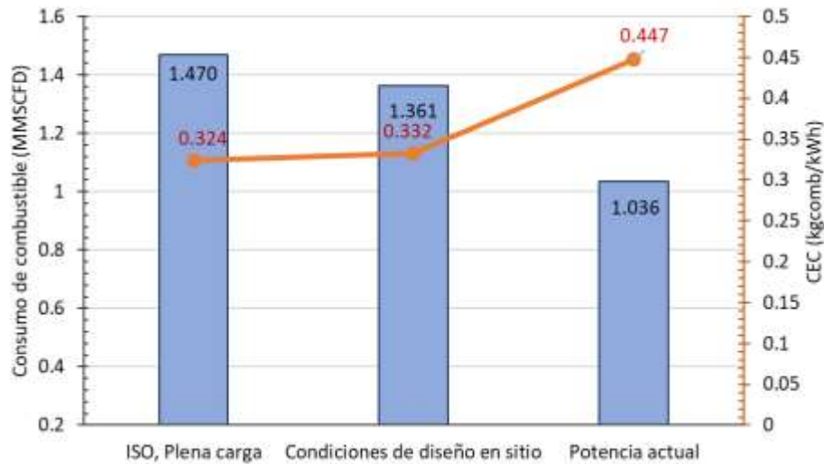
Figura 37. Consumo de combustible y CEC. Comparación Diseño ISO, condiciones en sitio y CO-3
