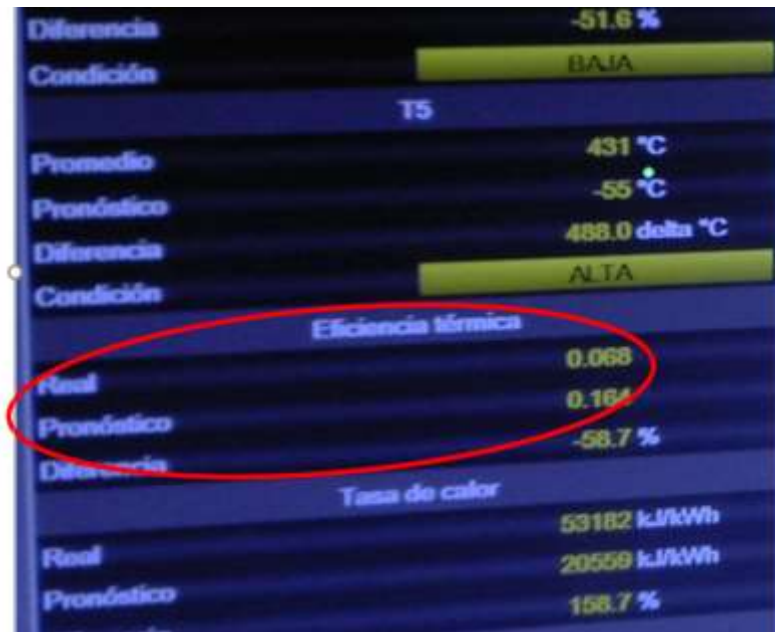
Figura 3. Estimaciones erróneas de una TG en operación
