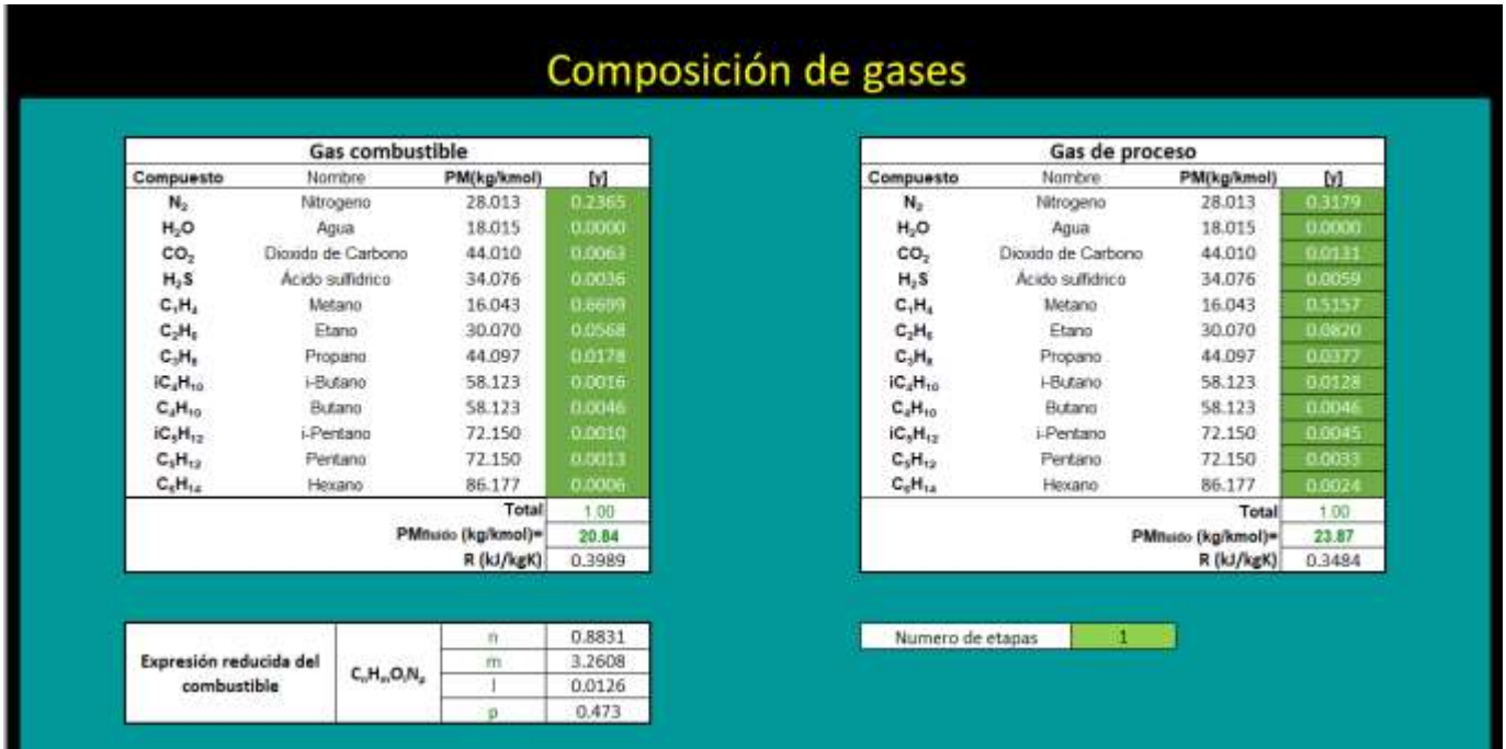
Figura 41. Hoja para la evaluación de pesos moleculares, constantes especificos de gases y obtención de expresión reducida del gas combustible
