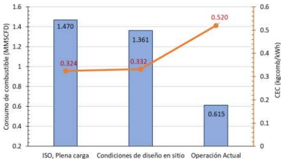
Figura 31. Consumo de combustible y CEC. Comparación Diseño ISO, condiciones en sitio y CO-1
