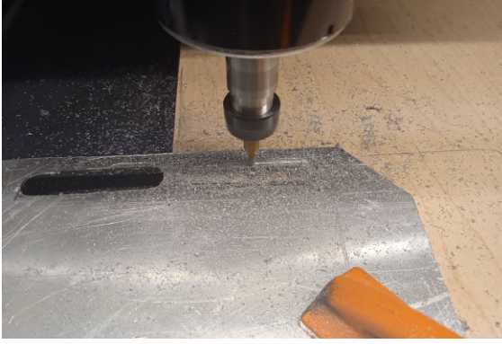
(a) Proceso de cortado de la lamina de aluminio.
