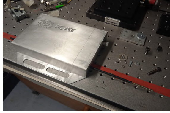
(b) Cubierta final ya grabada y terminada con el marco de plástico dentro.
