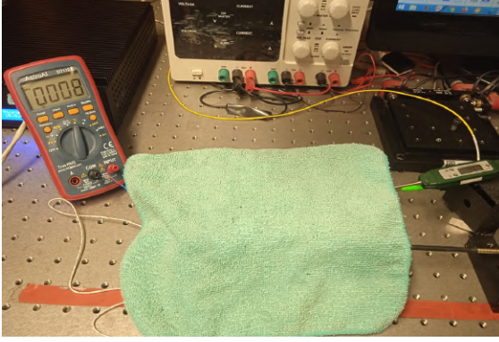
(a) Enfriamiento del sensor con gel congelado.
