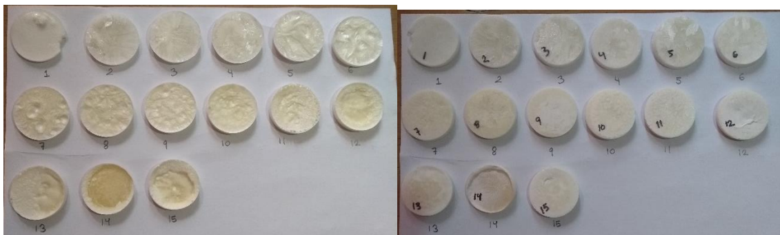
Figura 38. Cara anterior (izquierda) y posterior (derecha) de las membranas obtenidas de concentraciones de gelatina de pescado que van desde 0.42% a 17.48 % m/m.
