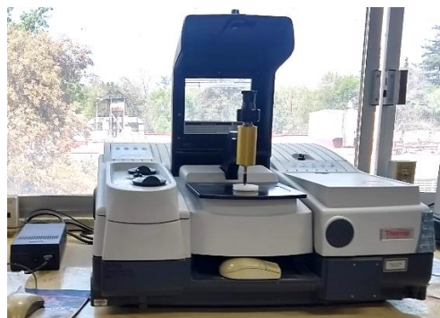
Figura 33. Espectrómetro FTIR modelo Nicolet 6700, marca Thermo Scientific.
