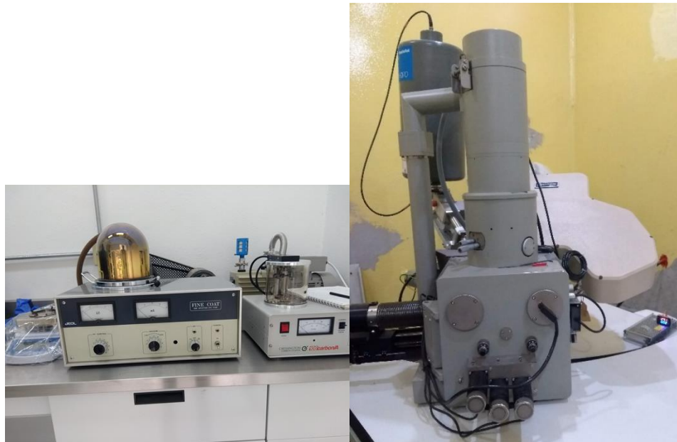
Figura 34. Evaporadora Fine Coat Ion sputter JFC-1100 (izquierda) y microscopio electrónico de barrido LEICA Stereoscan 440 (derecha).
