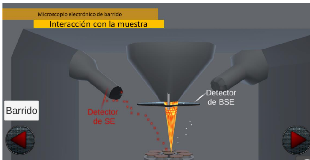
Figura 21 Detectores de las señales originadas por la interacción del haz con la muestra, donde SE son los electrones secundarios y los electrones retrodispersados son BSE. Imagen modificada de Microscopio electrónico virtual (Observatorio Ixtli UNAM) [78].
