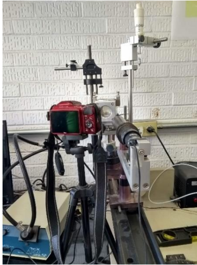
Figura 37. Equipo de medición de ángulo de contacto Ramehart, inc. con una cámara Nikon Coolpix adaptada sobre un tripié.
