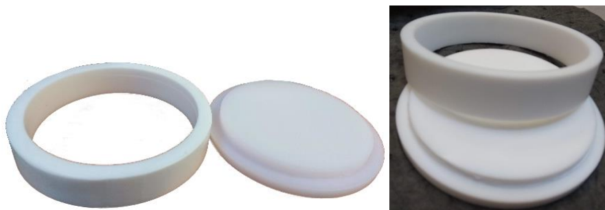
Figura 31. Moldes que se solicitaron a elaborar en el Taller del IIM, conformados por dos partes desarmables.
