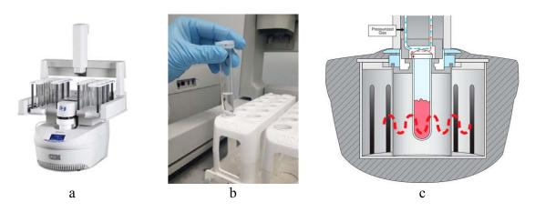
Figura 6.23. Equipo de calentamiento asistido por microondas CEM Discover SP®.
