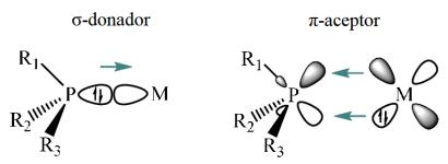
Figura 4.12. Efecto  $\sigma$ -donador y  $\pi$ -aceptor de ligantes fosfina a metales de transición
