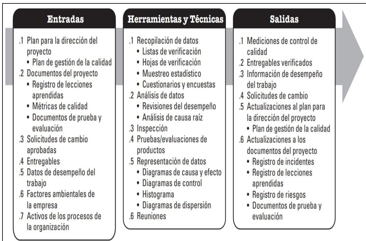
Gráfico 11. Entradas, herramientas, técnicas y salidas involucradas en el proceso de gestionar la calidad.
