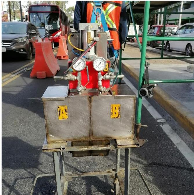
**Figura 61 Bomba de inyección mediante pistones utilizada en la L12 del Metro de la CDMX (Abarca, 2021)**
