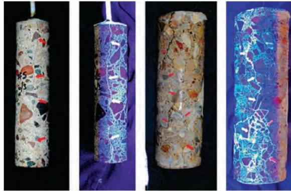
**Figura 33 Núcleos que muestran la penetración de la resina epoxi bajo luz negra (Goodwin et al., 2016)**
