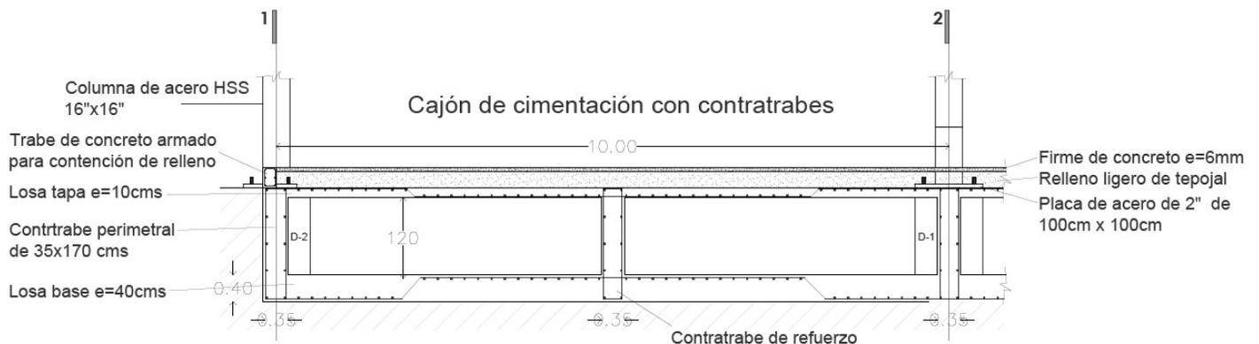
Imag. 62. Detalle de unión de columnas y dados. Imagen de autoría propia.
