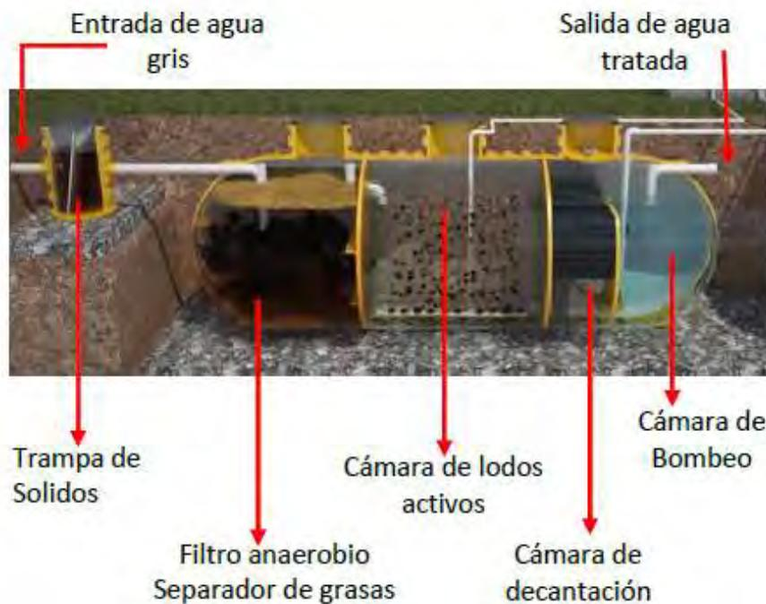
Imag. 104. Proceso de funcionamiento de planta de tratamiento.<sup>26</sup>
