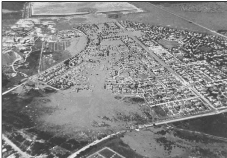
Figura 3.10. Vista aérea de la falla de la presa de residuos mineros de Merriespruit (Fourie & Papageorgiou, 2001).
