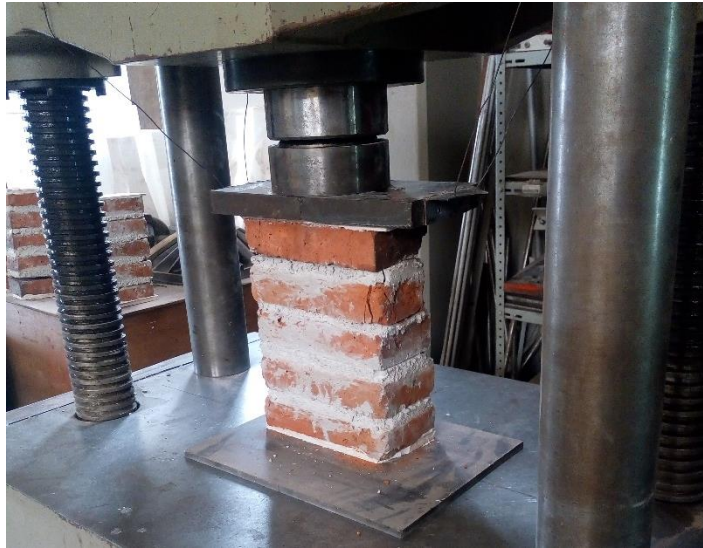
Figura 3.12. Prueba a compresión de pila de mampostería.
