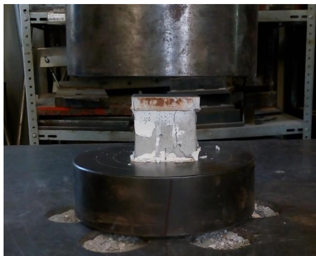
Figura 3.16. Pruebas de compresión a cubos de mortero.
