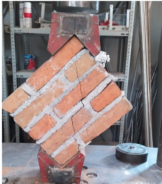
Figura 3.15. Pruebas a compresión diagonal a los muretes de mampostería.
