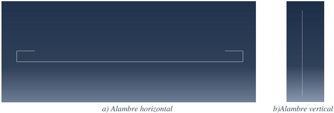
Figura 4.8. Alambres de la malla electrosoldada.
