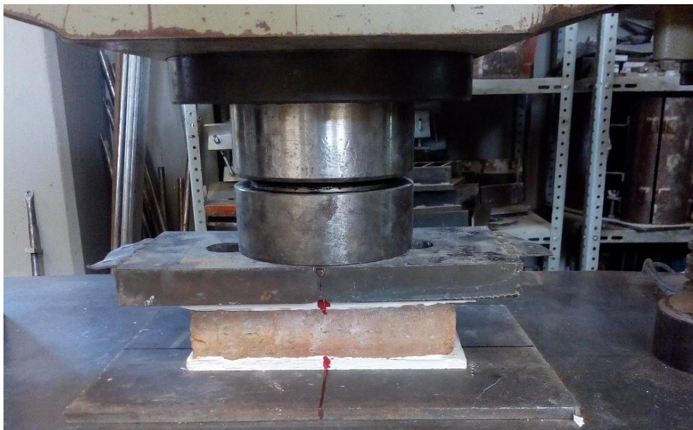
Figura 3.11. Pruebas a compresión de piezas de mampostería.
