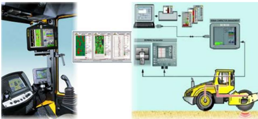
Fig. III.2.3 Esquema de compactacion inteligente en un rodillo BOMAG.
