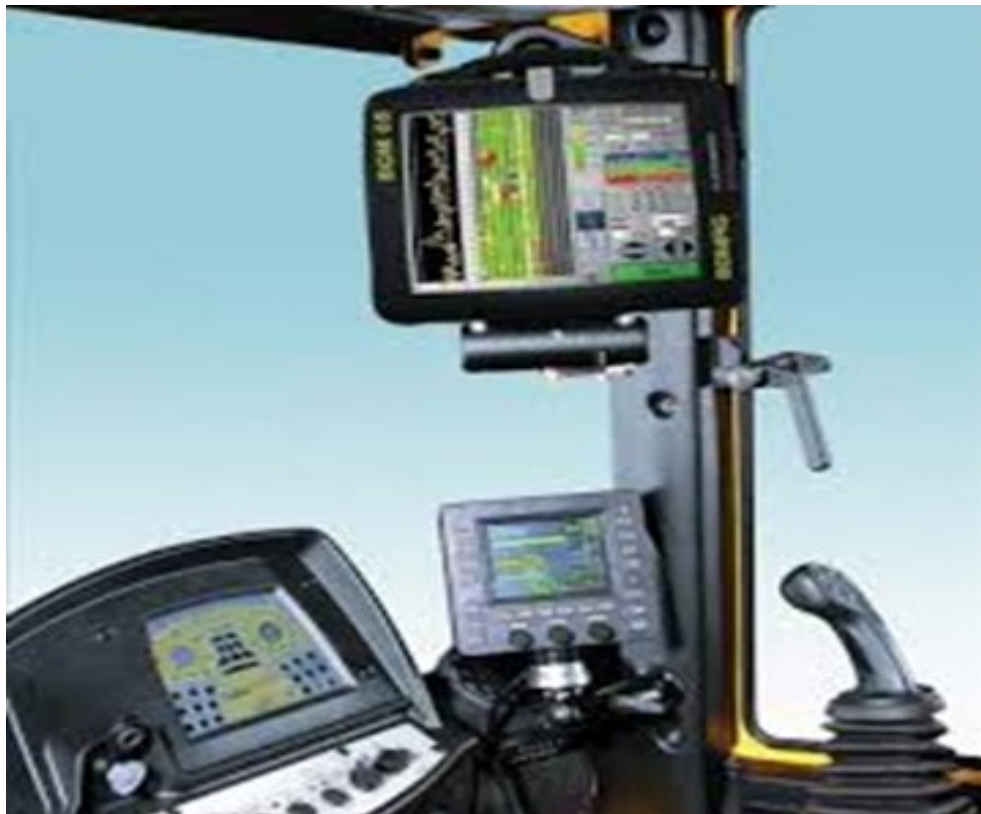
Fig.IV.2.3 Graficas de colores para monitoreo de la rigidez del material compactado.
