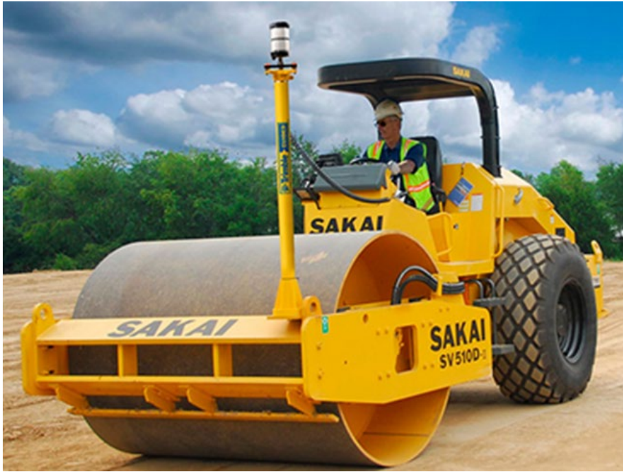
Fig. III.3.3 Compactador SAKAI con sistema GPS.
