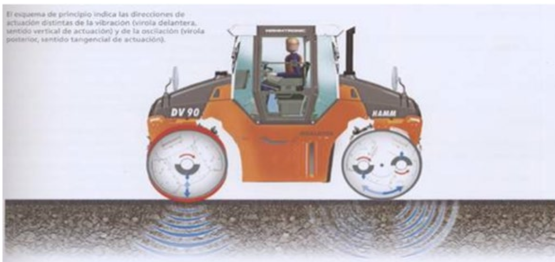
Fig.III.1.4 Esquema del compactador HAMM vibratorio / oscilatorio.
