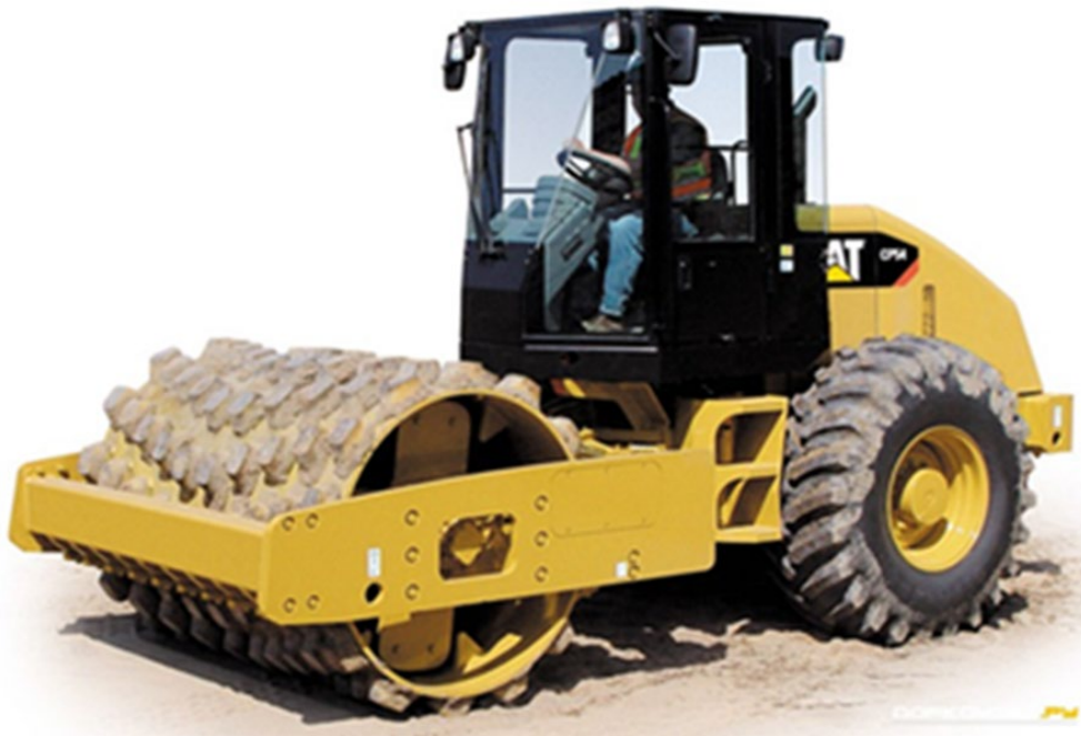
Fig. III.6.3 Compactador CATERPILLAR pata de cabra Con Tecnología IC.
