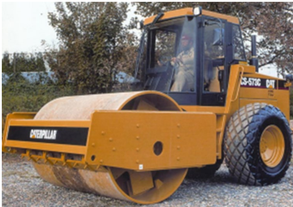
Fig. III.6.2 Compactador rodillo liso con sistema de compactacion inteligente.
