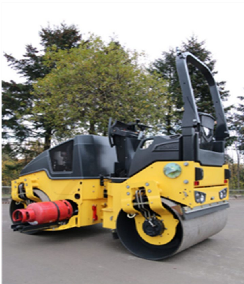
Fig. IV.3.1 Compactador en tándem con Motor de GAS
