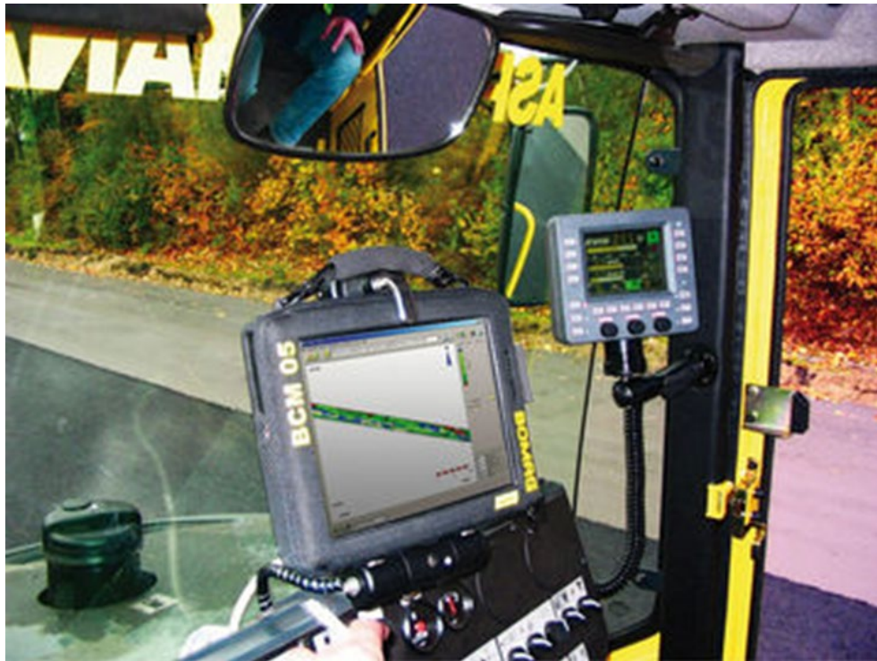
Fig.III.2.1 BOMAG. Control de la compactacion con el sistema ASPHALT MANAGER.
