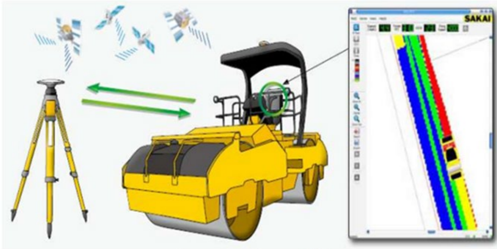
Fig.III.3.1 Esquema de Compactacion Inteligente de SAKAI.
