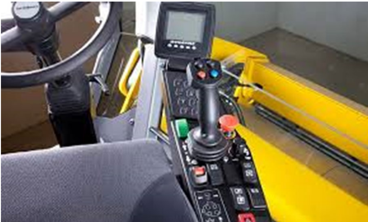
Fig.III.4.1 Interior de la cabina del compactador DYNAPAC.
