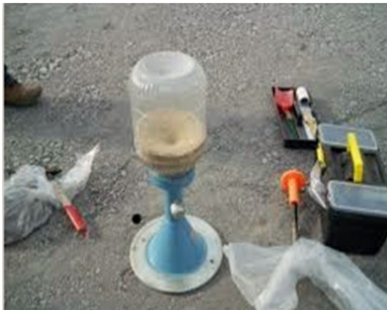
Fig. IV.4.1 Cono de arena para la prueba in situ.
