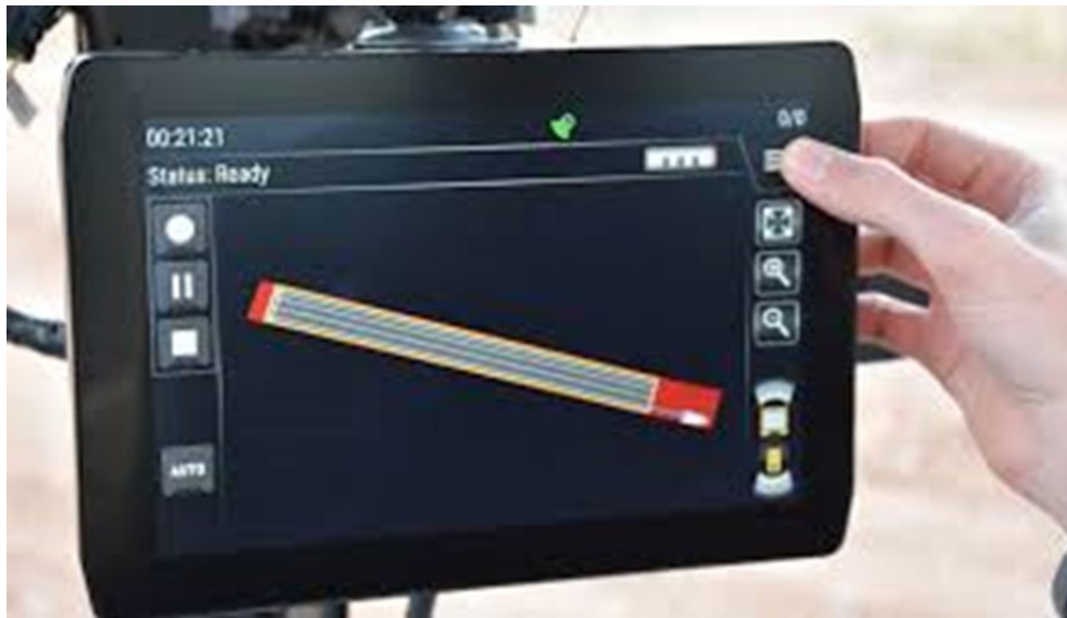
Fig.III.6.1 Pantalla de visualización del compactador vibratorio CATERPILLAR.
