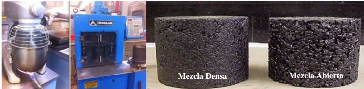
Figura 3.9. Proceso de fabricación de especímenes
