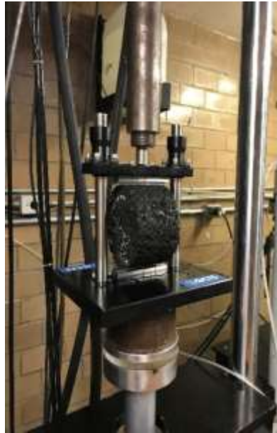
Figura 3.11. Ensayo de resistencia a la tensión indirecta en mezclas de concreto asfáltico
