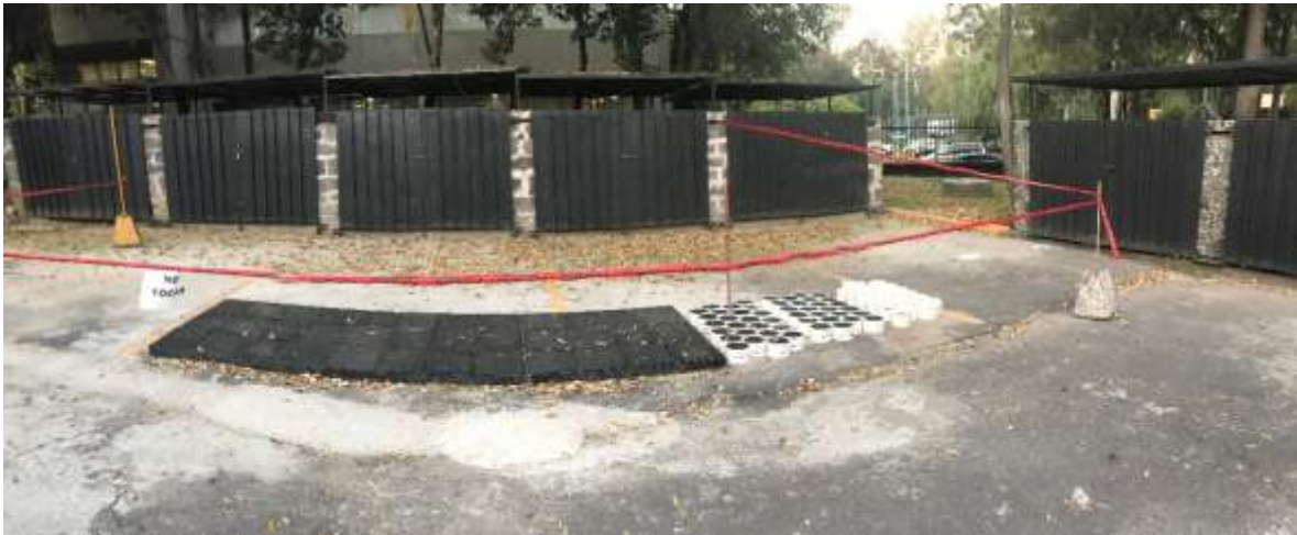
Figura 3.10. Especímenes de concreto asfáltico expuestos a ambientación natural por 6, 12 y 18 meses
