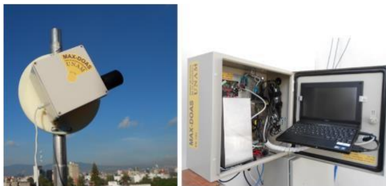
Imagen 15. Instrumentación de MAX-DOAS. El escáner se muestra en el lado izquierdo y el centro de control y adquisición se muestra al lado derecho de la imagen (Arellano, 2016).
