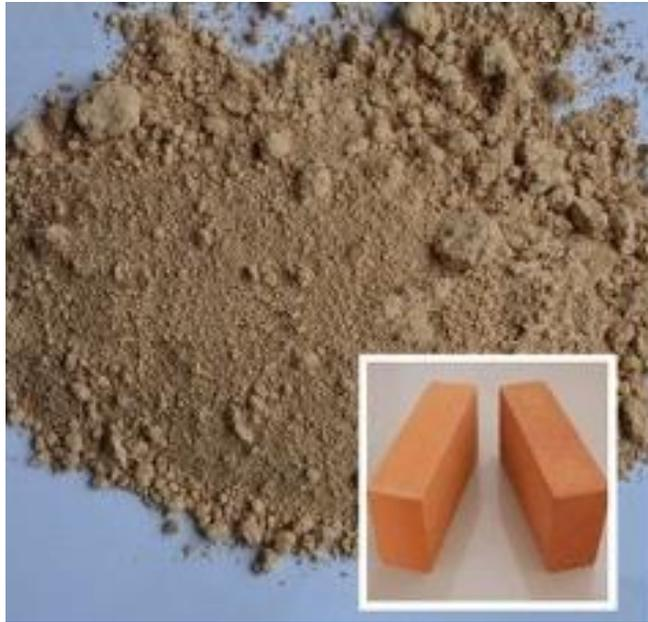
*Figura 2.7. - Tierra diatomácea pulverizada y ladrillos.*
