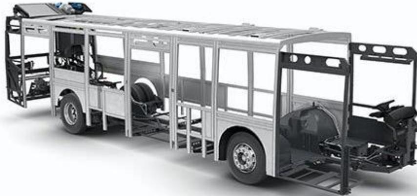
*Figura 4.10. - Autobús urbano con estructuras toldo y laterales fabricadas en aluminio. La estructura trasera, frontal y de piso están manufacturadas en acero.*
