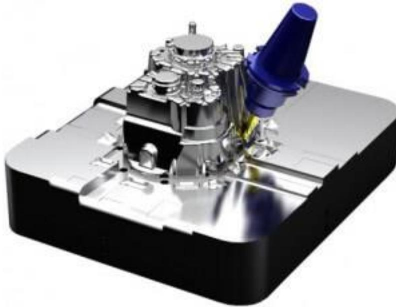
*Figura 4.17.- Simulación del mecanizado de una pieza metálica en software NX.*
