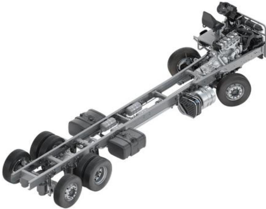
*Figura 4.5. - Chasis con motor frontal.*
