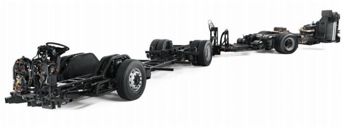
*Figura 4.9. - Chasis Articulado piso bajo y motor trasero Mercedes-Benz.*
