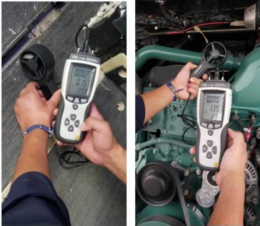
*Imagen 4.25. - Velocidad del aire en el área pasajeros (derecha) y compartimiento motor (izquierda).*
