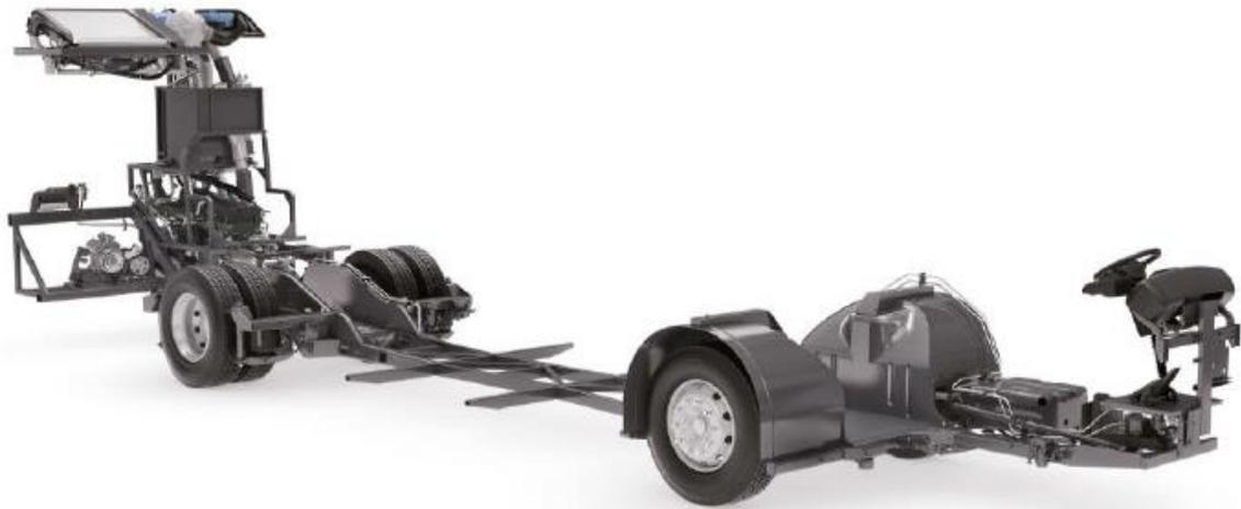
*Figura 4.6. - Chasis Volvo B9L piso bajo con motor vertical.*
