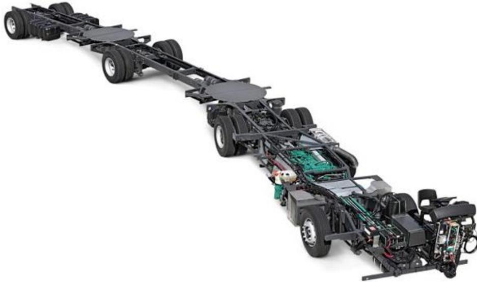
*Figura 4.8. - Chasis Biarticulado con motor en el carro delantero.*
