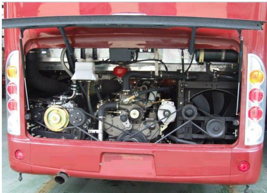
*Figura 4.20. - Motor y otros componentes en el compartimiento motor trasero. en el lado derecho se observa el radiador, al centro el motor y en el lado izquierdo el compresor y ducto de aire de admisión.*
