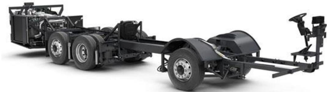
*Figura 4.7. - Chasis Volvo B11R (motor 11 litros) 6x2.*
