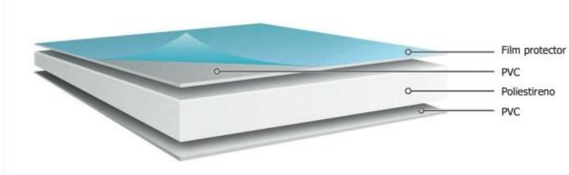
Figura 5.6. – Panel compuesto. Capas de PVC con núcleo de Espuma de Poliéstireno.
