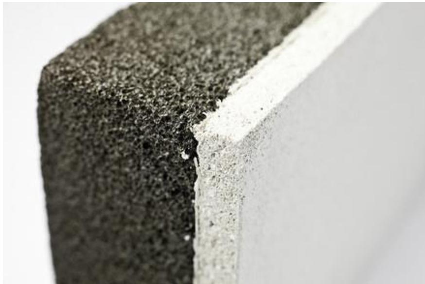
*Figura 2.9. - Loza de vidrio espumado con recubrimiento cerámico.*
