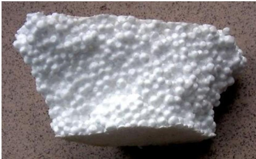
*Figura 2.11. - Fragmento de Poliestireno expandido.*
