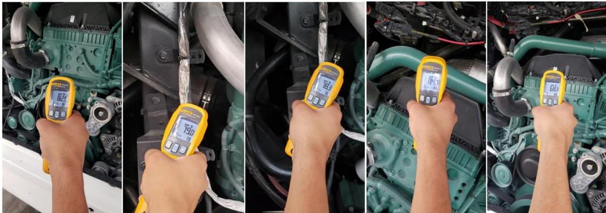
*Figura 4.24. - temperaturas de motor diésel Volvo de 13lt. Medición realizada con pirómetro digital.*
