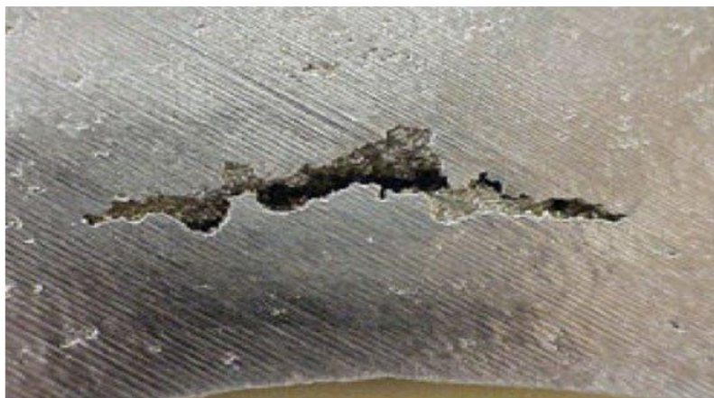
Figura 1.8 Porosidad por contracción. International Research Journal of Engineering and Technology (IRJET), 2020.
