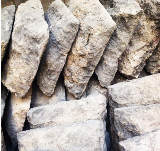
Imagen CIV. Sillares de piso enconchado. Fuente: fotografía CON.
