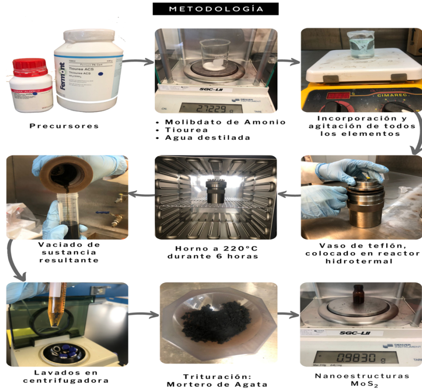
Figura 10. Metodología de síntesis hidrotermal de MoS 2 (Fuente propia)
