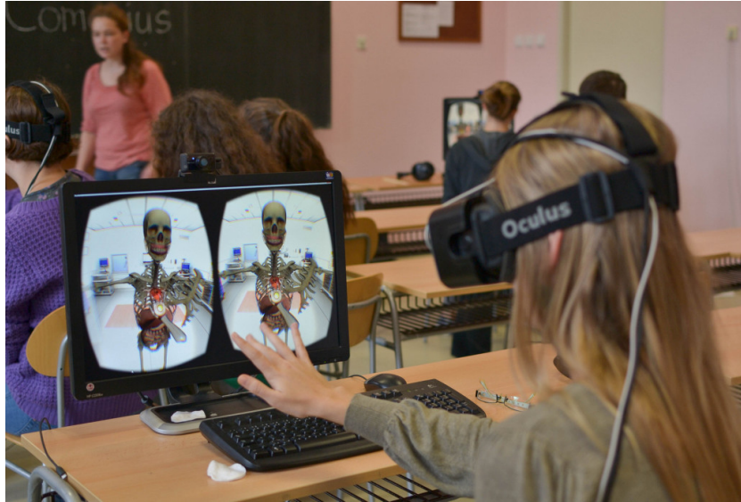
Figura 36: Sistema de VR, en el cual se utiliza una HMD estereoscópica, para situar al usuario dentro de un ambiente virtual.[46]
