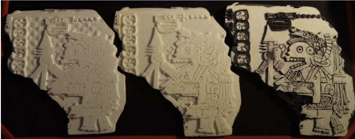
Figura 103: Impresiones 3d de uno de los modelos creados. A la izquierda se observa la impresión en TPU, la cual tiene la característica de ser flexible, al centro se muestra una impresión en PLA y a la derecha otra impresión en PLA pero con algunos de los detalles resaltados con pintura.
