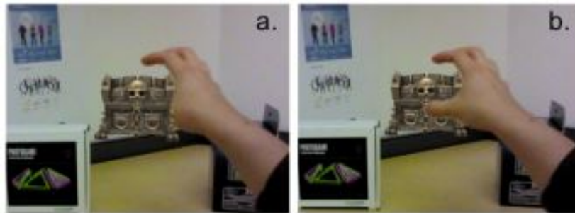
Figura 48: A la izquierda se observa un ejemplo de oclusión incorrecta y a la derecha se observa una correcta oclusión.[68]
