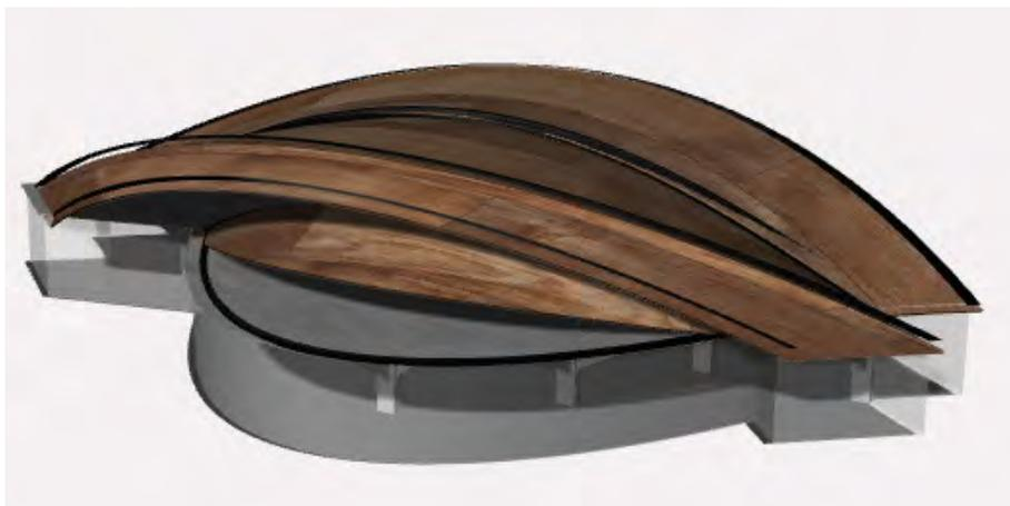
cubierta de material de aluminio con acabado tipo madera, alucobond plus.
