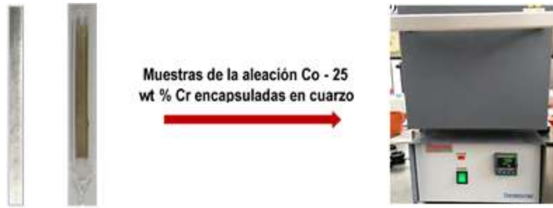
Figura 20. Esquema del proceso de tratamientos isotérmicos.
