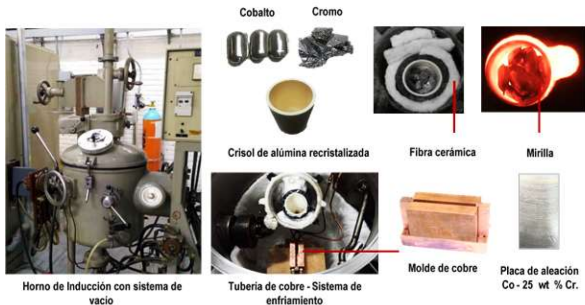
Figura 19. Esquema del proceso de fusión y solidificación.
