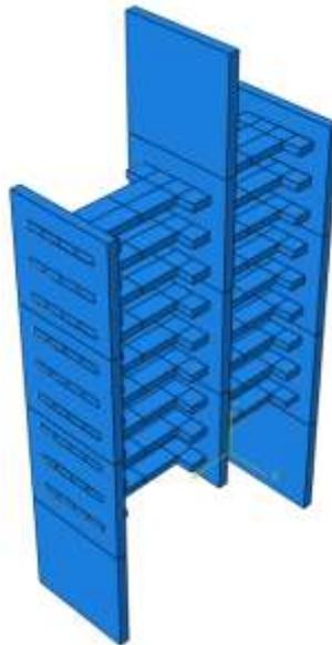
*Figura 4.6 Ensamble del modelo del disipador Dampo 1505 (Elaborado por el autor)*
