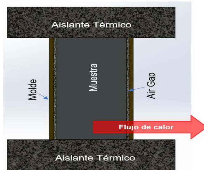
Figura 2.10 Sistema de bajo estudio para el cálculo de la transferencia de calor.
