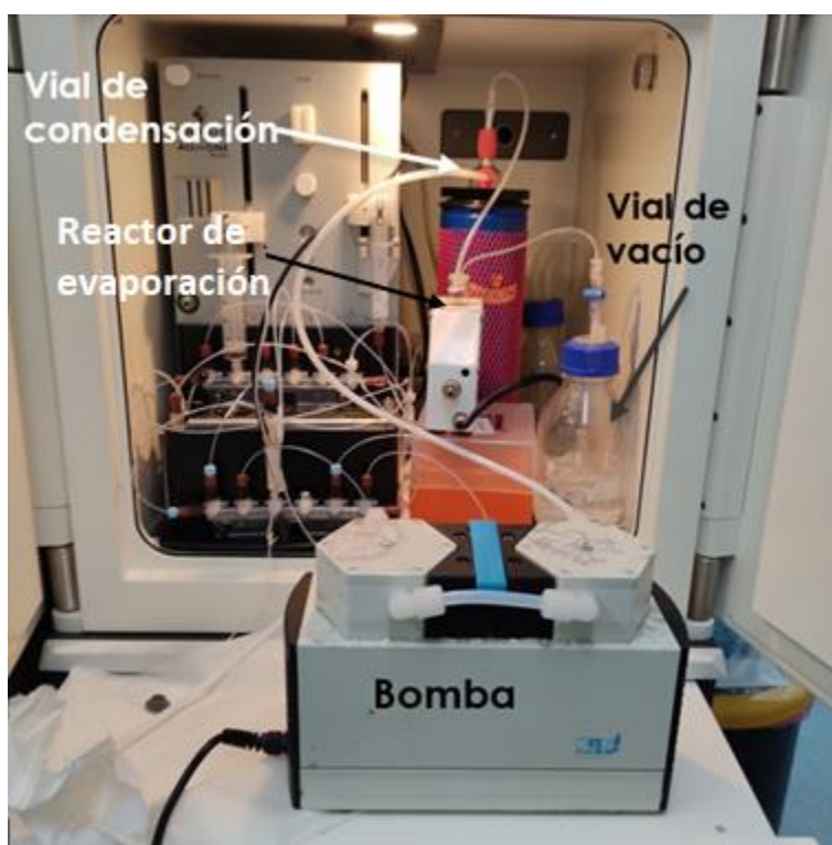
Figura 5.2. Montaje para la evaporación de la solución recuperada de ^{64}\text{Ni} en HCl 6M para su subsecuente electrodeposición.
