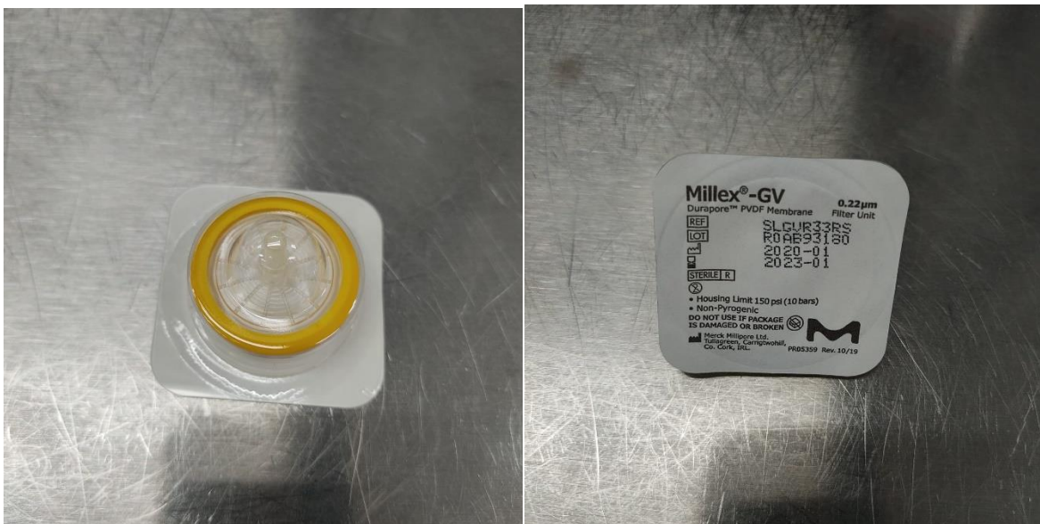
Figura 5.11. Filtro Millex GV Durapore de 0.22 \mu\text{m} .
