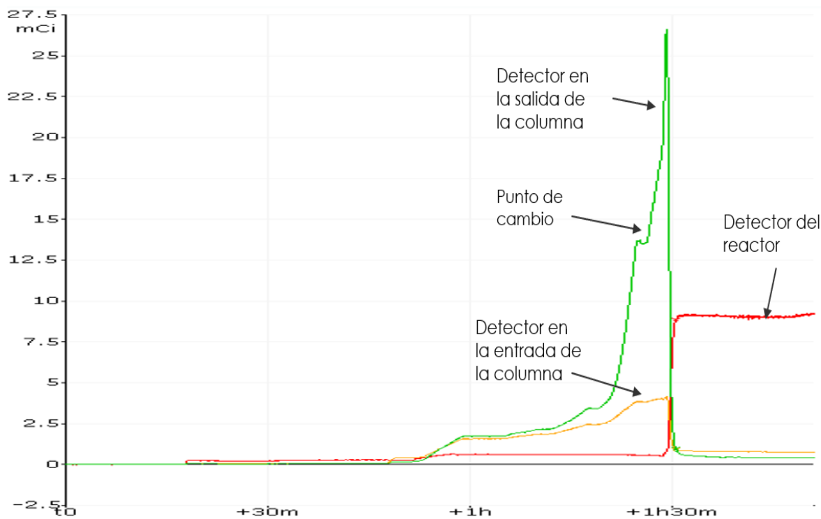
Figura 6.4. Perfil típico de elución medido por los distintos detectores de actividad en el módulo Trasis miniAiO.
