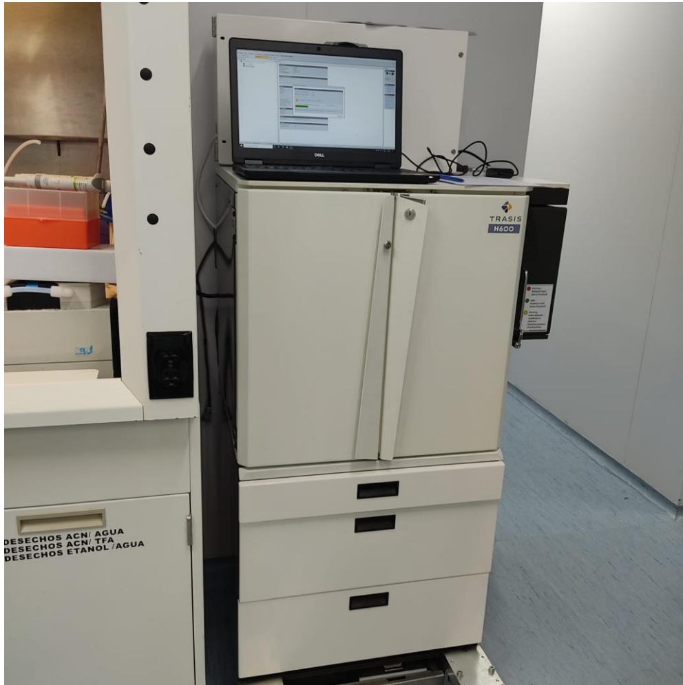
Figura 5.6. Vista de la celda Trasis H600 cerrada y la computadora con el software Trasis Supervision.
