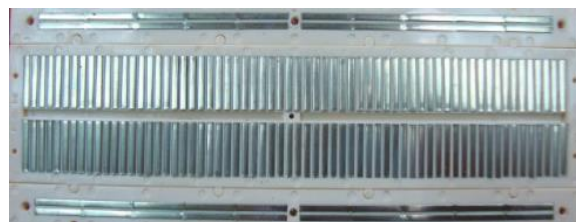
Figura 10. Conexiones internas de la placa protoboard basadas en láminas metálicas.
