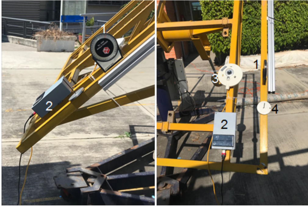
Figura 4.10: Experimento con control manual en heliótropo. 1 Inclinómetro, 2 Gabinete con sensor de irradiancia, 3 Piranómetro, 4 Gnomon
