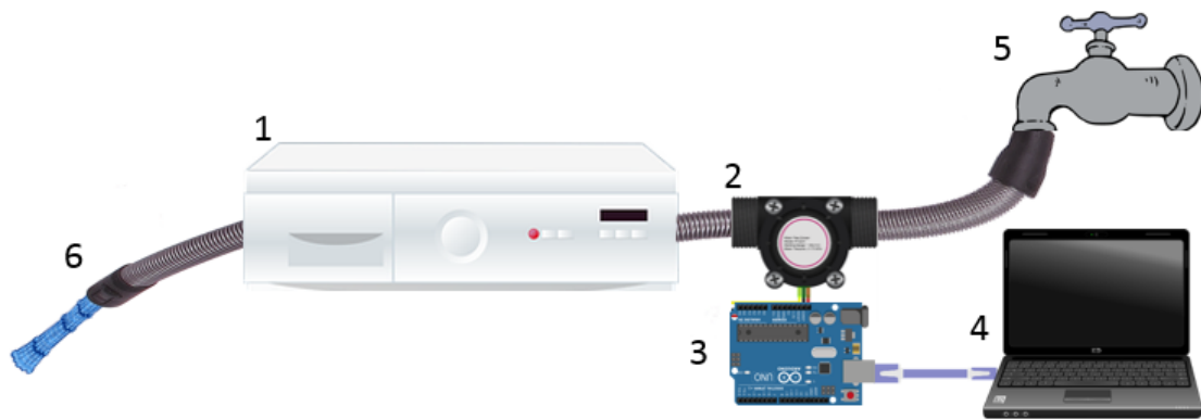
Figura 4.12: Esquema del sistema montado para calibración del caudalímetro. 1 Sistema de enfriamiento del horno solar, 2 Sensor YF-S201 a calibrar, 3 Arduino, 4 Ordenador, 5 Grifo de toma de agua, 6 Salida del agua.
