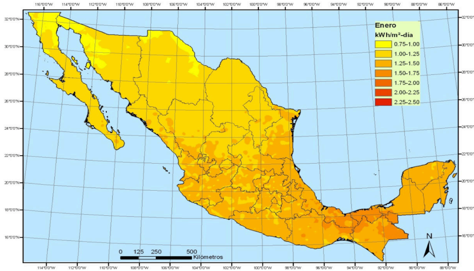
Fig 1.14 Difusa del mes de enero en \text{kWh}/\text{m}^2\text{día} (A.Tejada Martinez , G. Gómez Azpeitia 2015).
