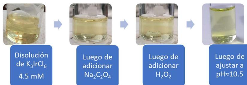
Figura 5.16. Cambios de color de la disolución de depósito de Ir(III) a medida se hicieron las adiciones de sus diferentes componentes.
