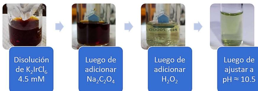
Figura 5.2. Cambios de color de la disolución de depósito de Ir(IV) a medida que se hicieron las adiciones de sus diferentes componentes.
