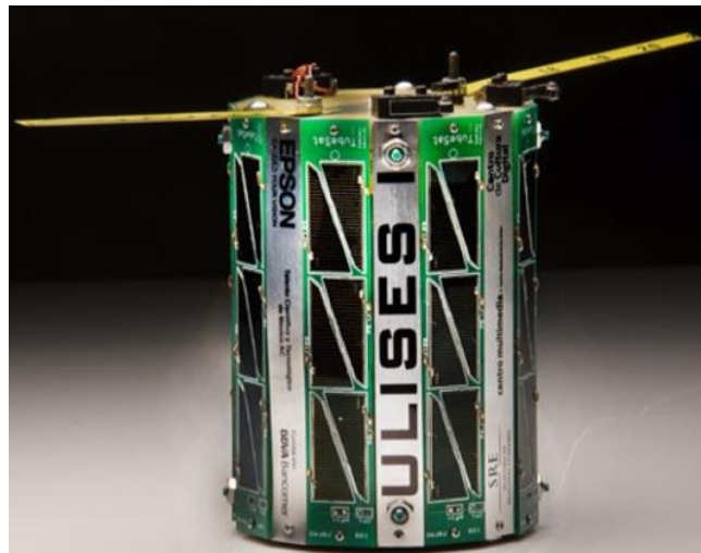
Figura 13. Nanosatélite Ulises 1 integrado
