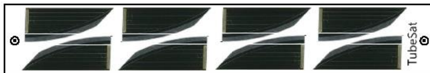
Figura 18. Arreglo con 8 celdas solares TrisolX.
