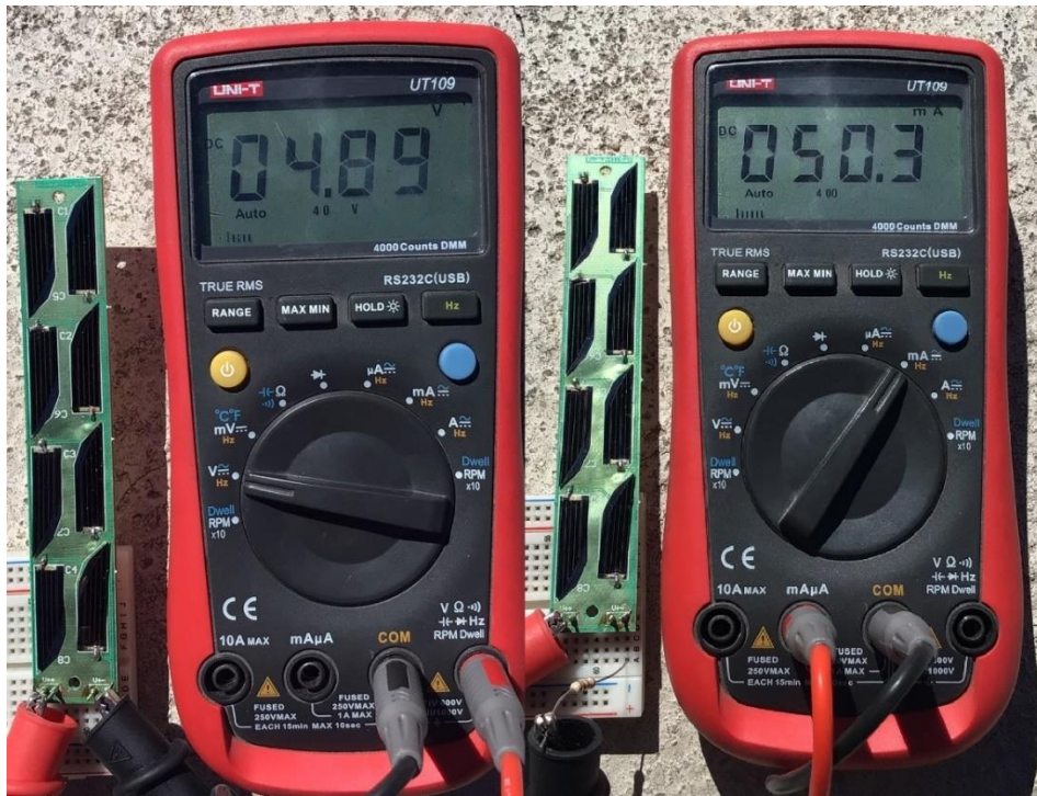
Figura 58. Mediciones del panel solar cuando está iluminado por el Sol, voltaje (izquierda) y corriente (derecha).
