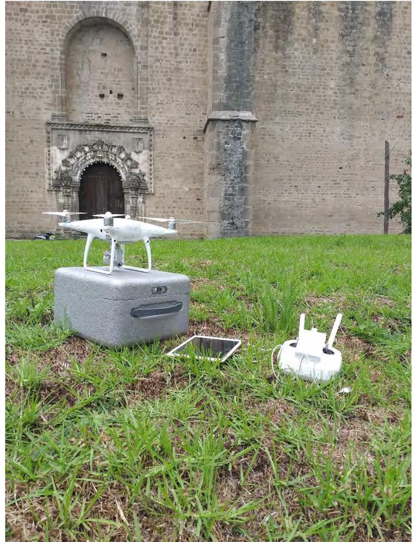
Fig. 6.19. Scanner láser y dron para la realización del levantamiento del Convento de San Miguel Huejotzingo, 2019.
