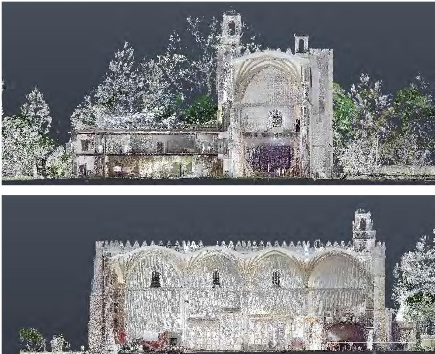
*Fig. 6. 20. Cortes transversal y longitudinal del Convento de San Miguel por medio de nube de puntos.*
