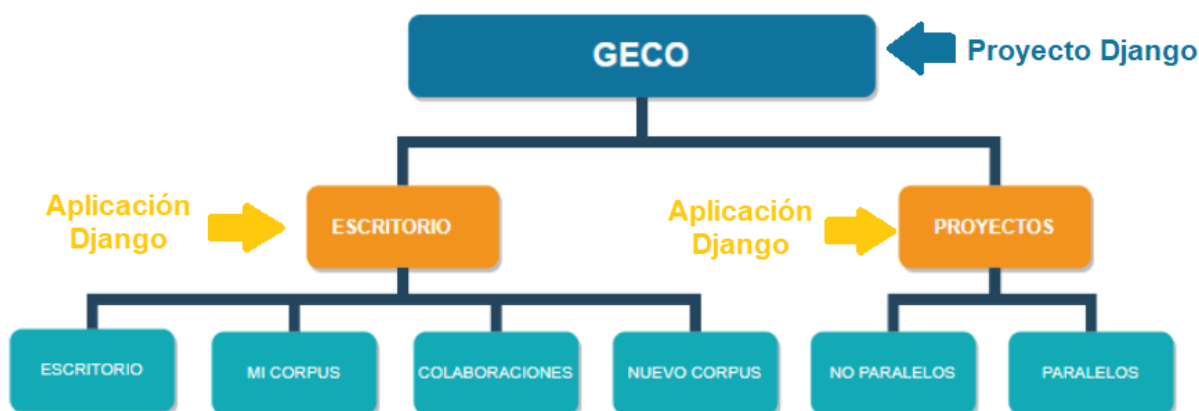
Figura 23: Diagrama de “Organización de Aplicaciones y Proyectos” del sistema GECO4
