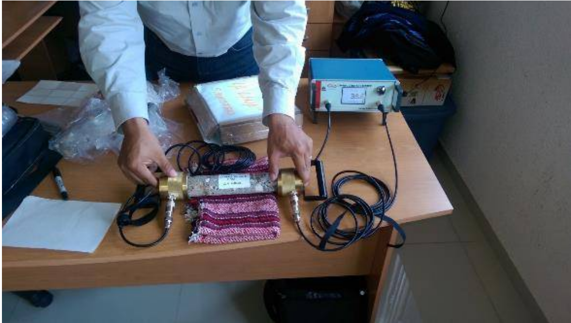
Figura 14. Se muestra el momento de practicar la prueba de velocidad al corazón de concreto obtenido de todos los elementos..
