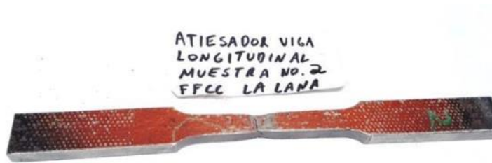
Figura 28. Probeta formada de la muestra extraída
