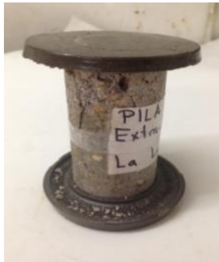
Figura 25. Muestra después de ser sometida a la prueba de compresión simple
