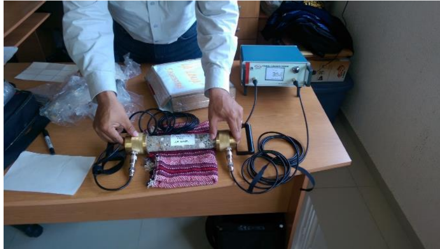
Figura 32. Prueba de velocidad al corazón de concreto obtenido
