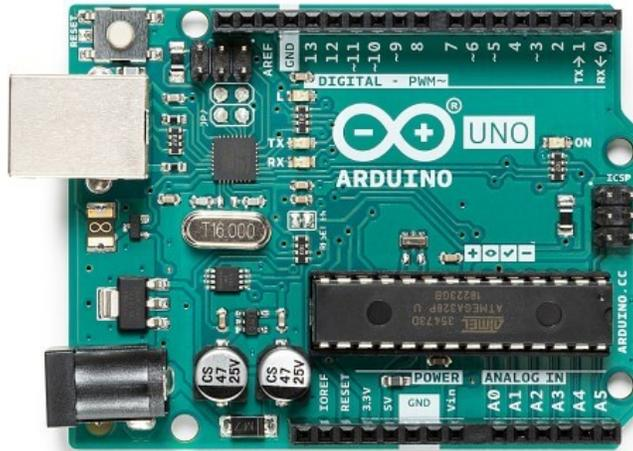
Figura 1.4.1: Placa Arduino UNO [1]
