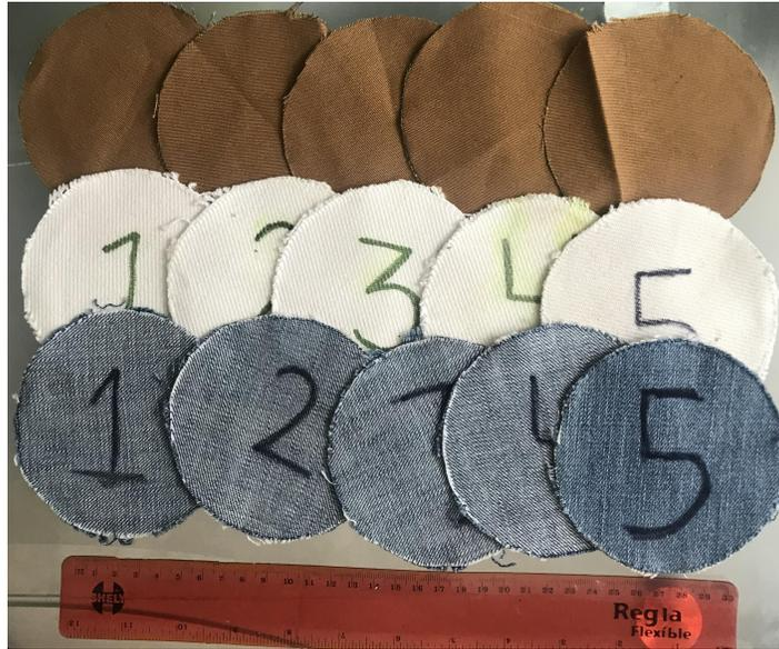
**Figura 2.5.1:** Medios filtrantes empleados en las pruebas de filtración. Arriba, tergal. En medio, lona. Abajo, mezclilla.
