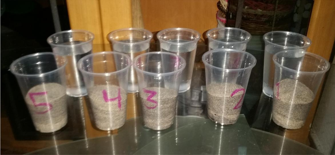
**Figura 2.5.2:** Vasos con el mineral y el líquido a filtrar
