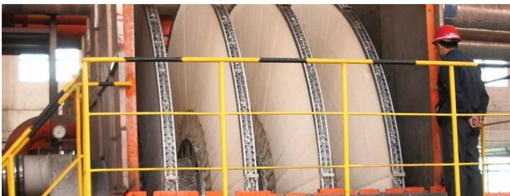
**Figura 1.1.5:** Filtro de disco rotatorio [17]
