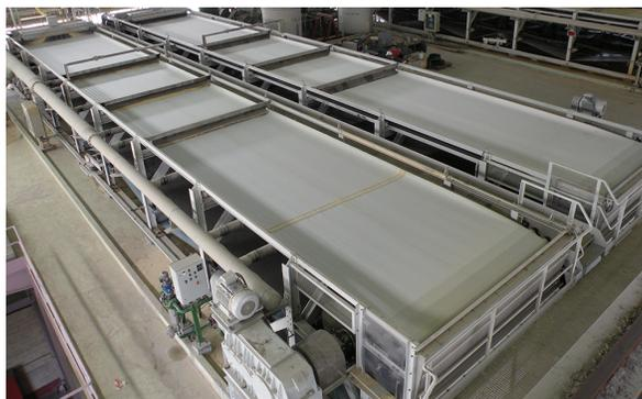
**Figura 1.1.6:** Filtro de banda al vacío [23]
