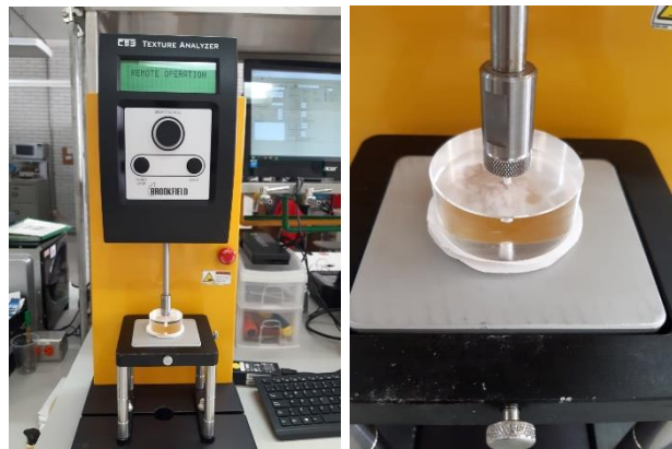
Figura 8. Prueba de Capacidad de Retención de Agua en fajitas de pechuga de pollo en texturometro CT3 de Brookfield®.
