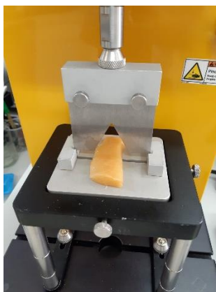
Figura 9. Prueba de resistencia al corte en fajitas de pechuga de pollo realizada en el texturómetro CT3 de Brookfield®.
