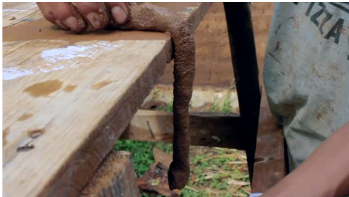
Figura 91. Prueba de resistencia de mezcla. Nota. (MEDES y ASF. 2013, 3m36s)
