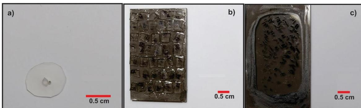
**Figura 1.6** Preparación de muestras, a) cristal de cuarzo con inclusiones de vidrio en forma de oblea, b) portamuestra con cubierta de carbón y cristales que contienen inclusiones de vidrio, y c) portamuestra con cubierta de carbón y cristales de anfíbol.
