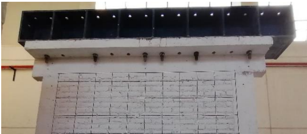
Figura 3.19. Colocación de viga horizontal para distribución de carga.
