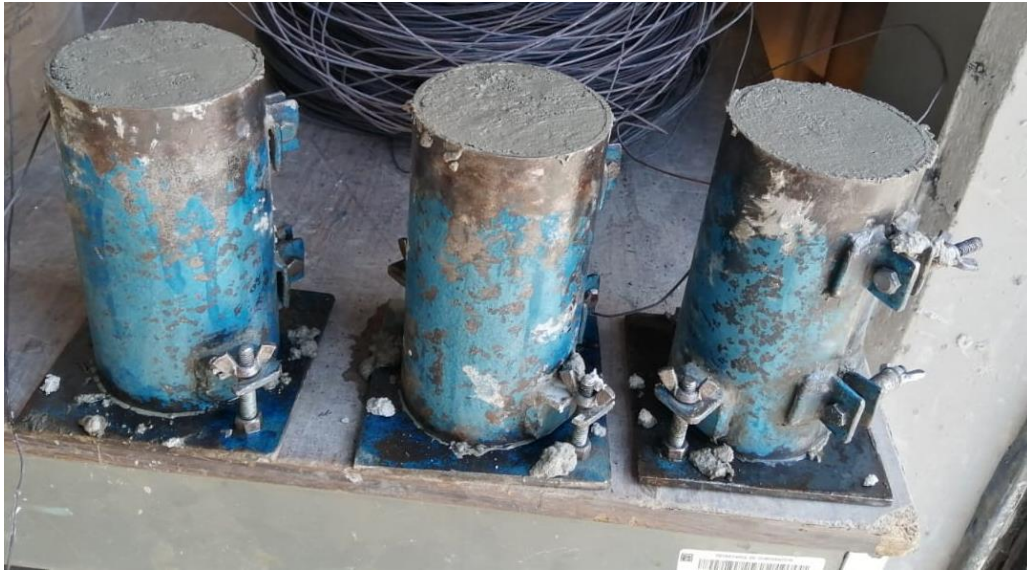
Figura 3.4. Cilindros de concreto para compresión axial.
