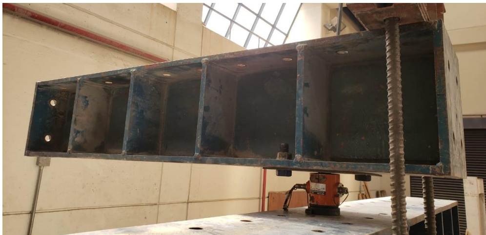
Figura 3.20. Viga para contrapeso sobre celda de carga.
