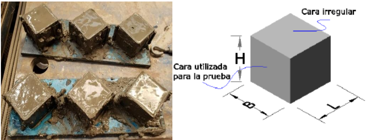
Figura 3.3. Cubos de mortero para ensaye.
