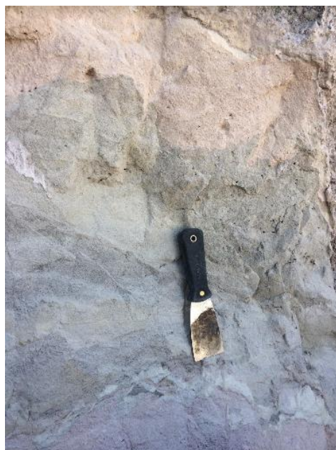
Figura 4.1 Ñ. Fotografía de la unidad ignimbrita en el depósito DER 19131 que muestra A) la capa rosada (arriba) y B) la capa verdosa (abajo) donde se nota el contacto irregular, pero claro entre ambas capas. Escala: espátula de 15 cm.
