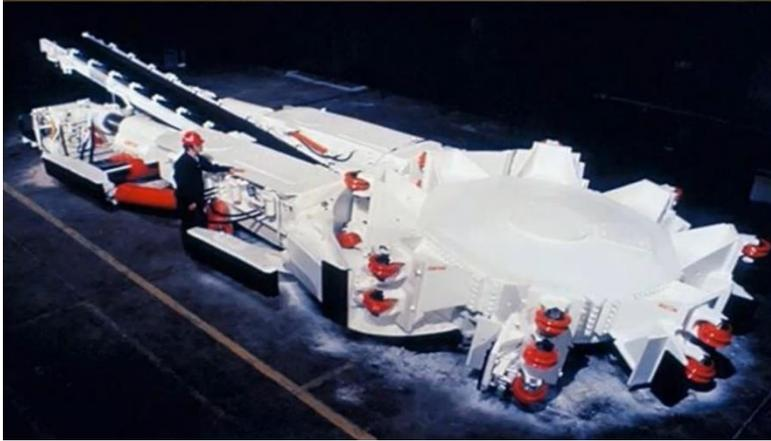
utilizaba para minar la parte inferior del manto una vez que había sido extraído por otros métodos. Es notable observar que únicamente la mitad de los discos de corte atacan el frente de excavación.
