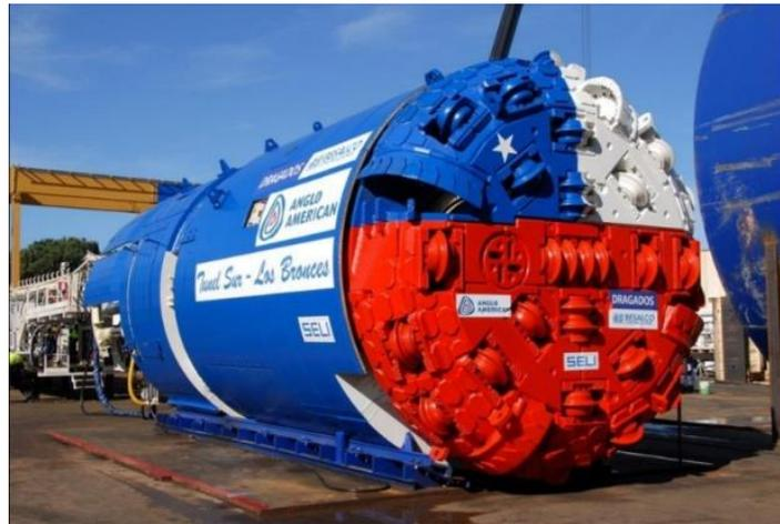
Figura 3.16 Tuneladora híbrida usada en mina Los Bronces (SME)
