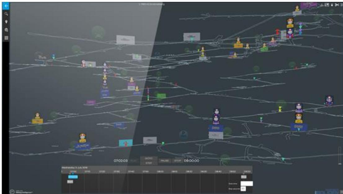
Figura 6.26 Visualización digital de la mina en tiempo real (Mobilaris.com)
