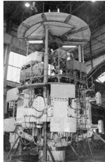
Figura 1.12 Shaft boring machine, barreno piloto. (Op. Cit.)
