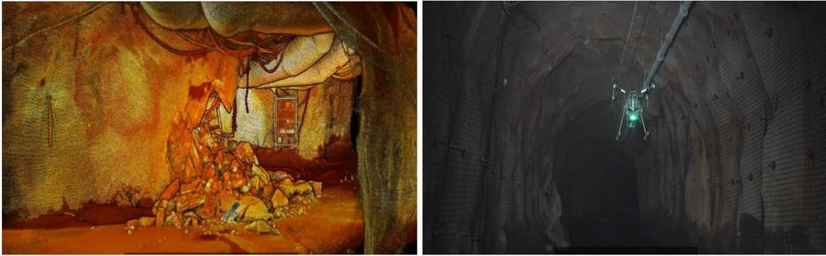
Figura 6.22 izq. Levantamiento con sistema Lidar, Der. Uso de drones en mina LKAB (<https://www.emesent.io/>)
