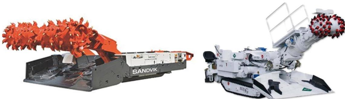
Figura 4.15 con cabeza rectangular Fuente:Sandvik (izq.) y con rozadora Fuente:Alpine (der.)
