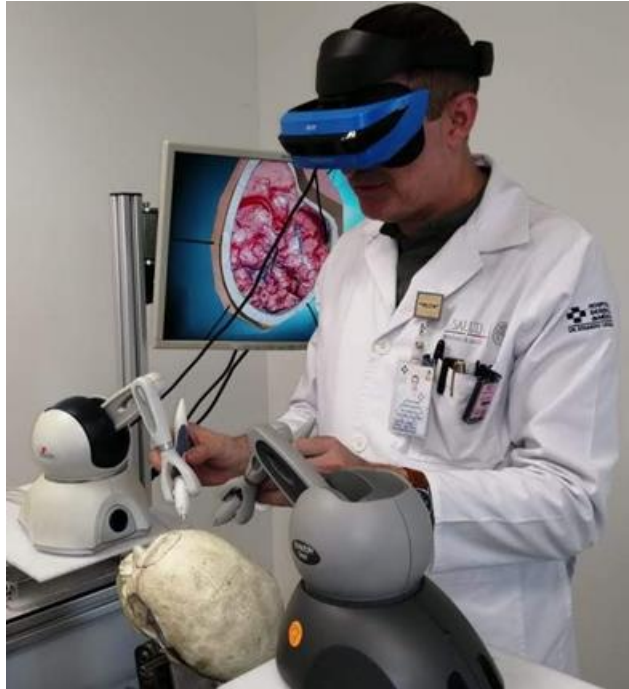
Fig. 2 Imagen del simulador híbrido BACSIM para clipaje de aneurismas. Se aprecia que el usuario interactúa con el simulador por medio de dispositivos hápticos mientras observa la escena a través de un casco de realidad virtual.
