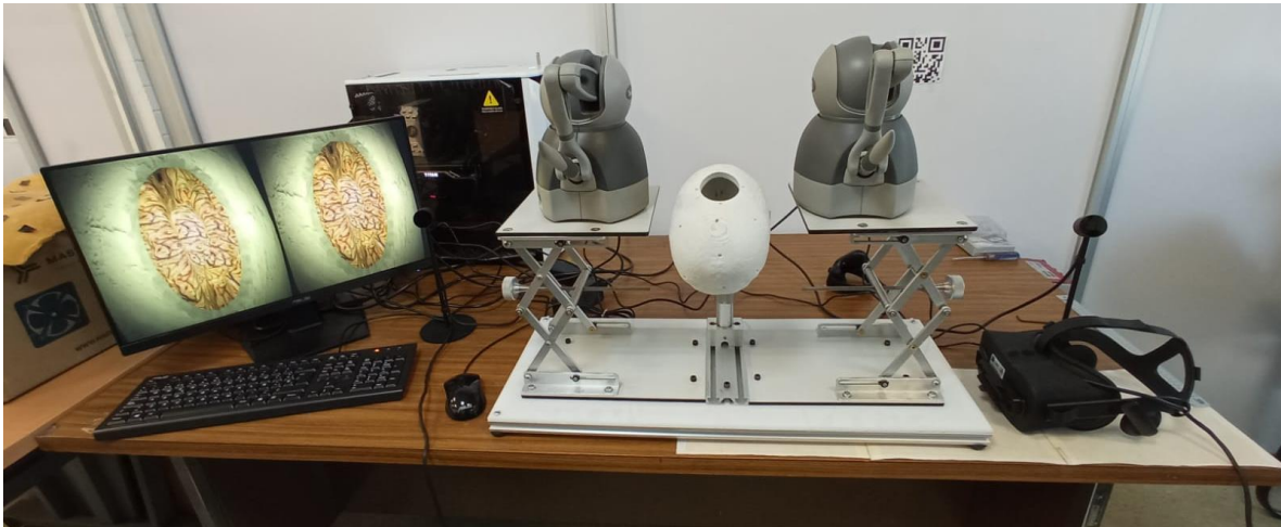
Fig. 9 Versión final del simulador. Del lado izquierdo en la computadora se aprecia la escena de simulación y del lado derecho, la estación de trabajo con el hardware externo y los elementos físicos. Fuente: elaboración propia.
