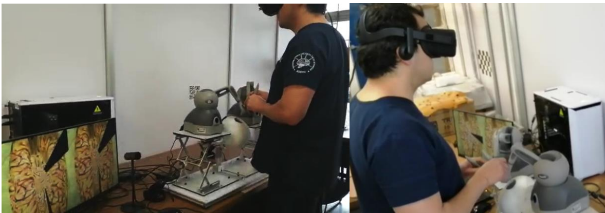
Fig. 39 Imágenes del Dr. Isaac Enrique Tello Mata probando el simulador. Se aprecia que tiene colocado el casco de realidad virtual y está manipulando los dispositivos hápticos. En la pantalla de la computadora se puede ver lo que está viendo el neurocirujano en el casco.
