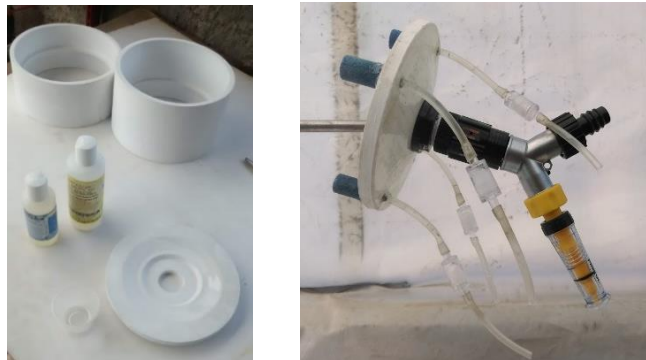
Figura 60. Se muestran (izquierda) las primeras piezas del disco inferior y superior fabricadas para la primera versión del prototipo. Figura 61. Se muestra (derecha) la configuración inicial del disco inferior, con salida de ½ pulgada y flujo dividido para muestreo.
