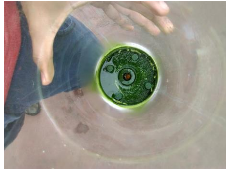
Figura 64. Se muestra evidencia fotográfica de la sedimentación ocasionada por el uso del deflector.
