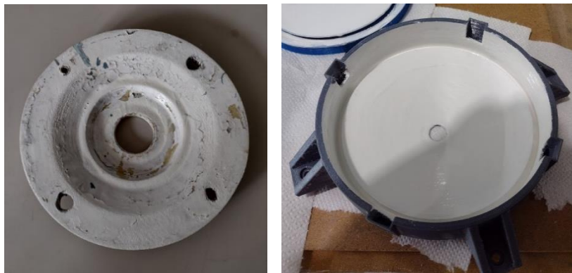
Figura 63. Se muestra evidencia fotográfica del desgaste ocurrido en el primer disco (izquierda), por lo que se optó por un recubrimiento con resina epóxica grado alimenticio a cada uno de los componentes del FBR (derecha).
