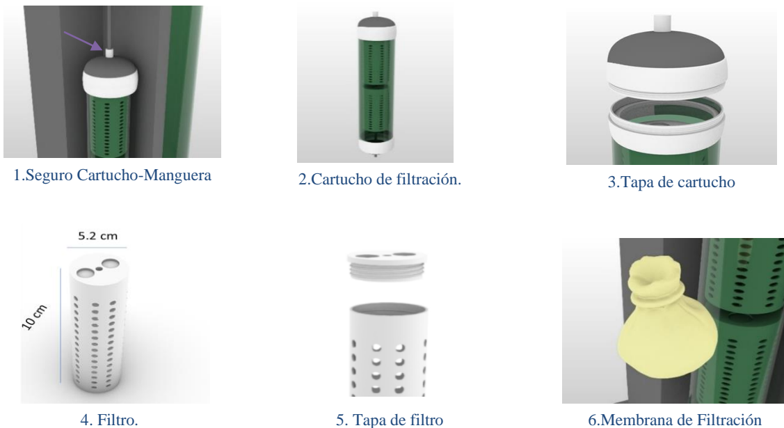
Figura 49. Se muestran los componentes del sistema de filtración con los que el usuario tendrá interacción para el proceso de recuperación de la biomasa filtrada. Fuente elaboración propia.
