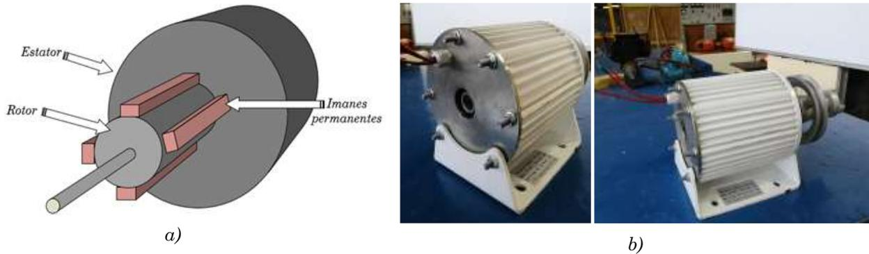
**Figura 3.3.** a) Dibujo representativo de un generador síncrono de imanes permanentes de dos pares de polos, b) Generador síncrono físicamente.
