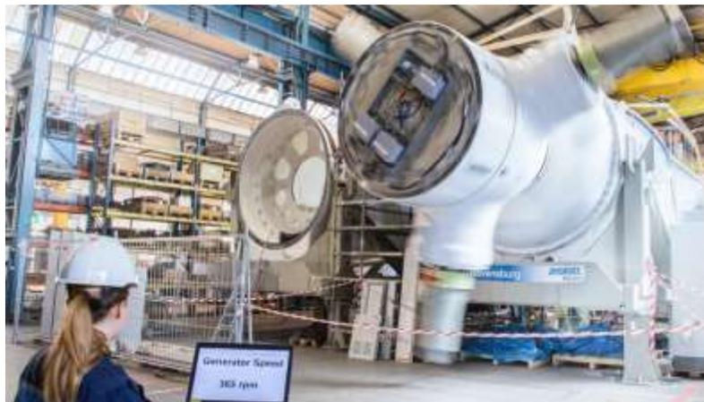
**Figura 2.6.** Prueba del funcionamiento de una de las turbinas para el proyecto MeyGen, [2.10].
