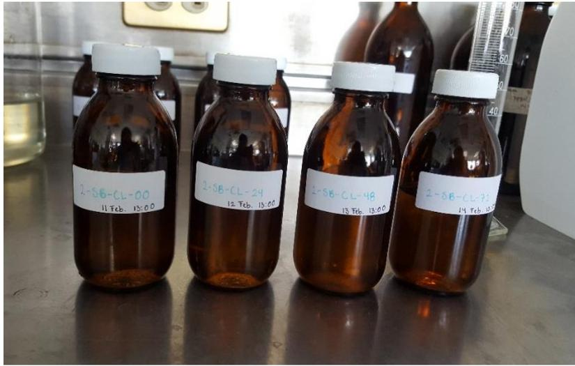
Figura 3.18 Alícuotas del producto hidrodesulfurado sin barrido con nitrógeno pero lavado con solución cáustica del 2° punto experimental (2-SB-CL) analizadas a las 0, 24, 48 y 72 horas después del lavado.
