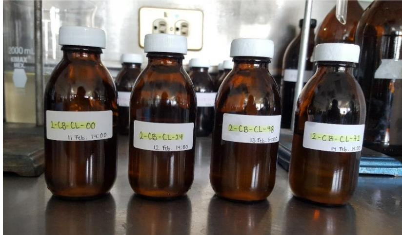
Figura 3.23 Alícuotas del producto hidrodesulfurado barrido con nitrógeno y lavado con solución cáustica del 2º punto experimental (2-CB-CL) analizadas a las 0, 24, 48 y 72 horas después del barrido y lavado.
