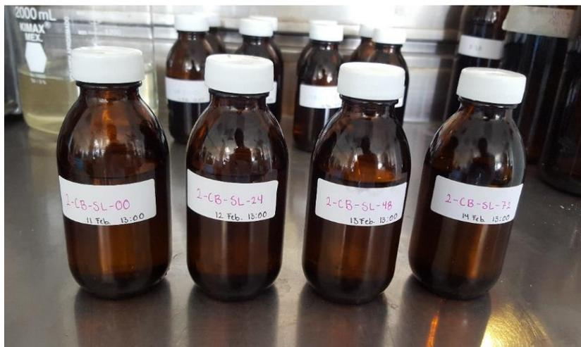
Figura 3.20 Alícuotas del producto hidrodesulfurado barrido con nitrógeno pero sin lavado con solución cáustica del 2º punto experimental (2-CB-SL) analizadas a las 0, 24, 48 y 72 horas después del barrido.
