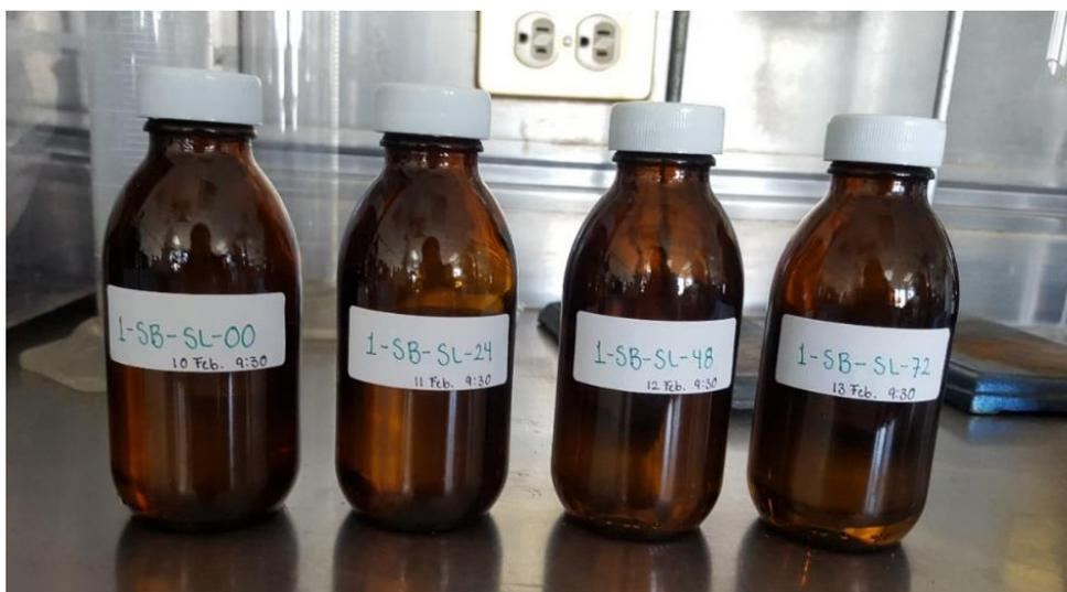
Figura 3.1 Alícuotas del producto hidrodesulfurado sin barrido con nitrógeno y sin lavado con solución cáustica del 1er punto experimental (1-SB-SL) analizadas a las 0, 24, 48 y 72 horas.
