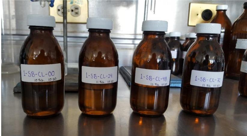
Figura 3.5 Alícuotas del producto hidrodesulfurado sin barrido con nitrógeno, pero lavado con solución cáustica del 1er punto experimental (1-SB-CL) analizadas a las 0, 24, 48 y 72 horas después del lavado.
