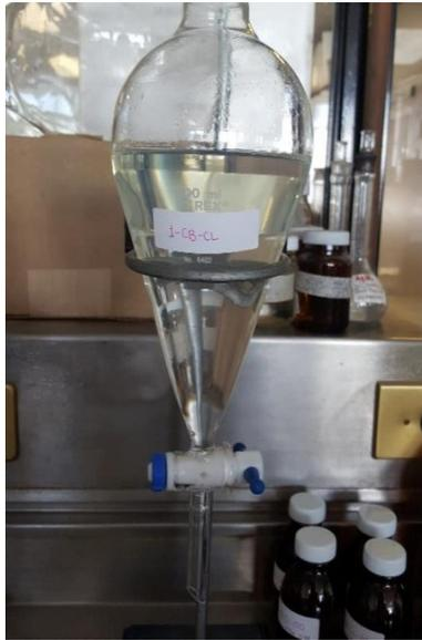
Figura 3.9 Lavado del producto hidrodesulfurado con barrido con nitrógeno del 1er punto experimental (1-CB-CL).
