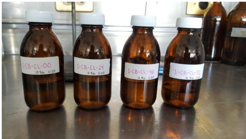
Figura 3.10 Alícuotas del producto hidrodesulfurado barrido con nitrógeno y lavado con solución cáustica del 1er punto experimental (1-CB-CL) analizadas a las 0, 24, 48 y 72 horas después del barrido y lavado.
