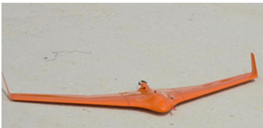
Figura 9. Dron “C-Astral Bramor-Geo” (dron de ala fija) utilizado para los levantamientos fotogramétricos del estudio, junto con el material necesario para su lanzamiento.
