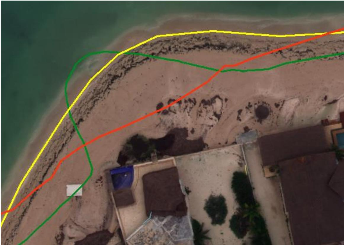
Figura 18. Imagen a color del monitoreo del 12/2017 de la zona principal de influencia del rompeolas de San Miguel, señalando la línea de costa para los tres periodos (rojo - 12/2016, verde - 07/2017 y amarillo - 12/2017) utilizados para determinar el cambio de la línea de costa.
